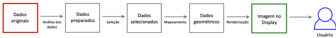
Figura 4 – Pipeline da visualização de informação utilizado neste trabalho. Baseado em proposta apresentada em (WARD; GRINSTEIN; KEIM, 2015)
