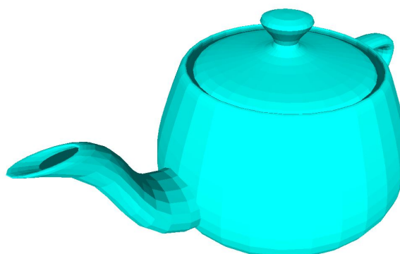
Figura 2 – Representação de um bule em uma malha de vértices.
