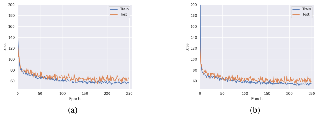
Figura 21 – Curva da função de custo, para treinamento e teste, referindo-se 1 dos 5 folds , para as redes YOLOv3 de um estágio (a) e dois estágios (b).
