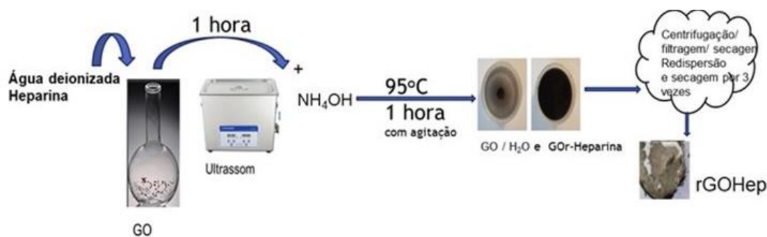
Figura 4.10 - Esquema para a obtenção de rGO.
