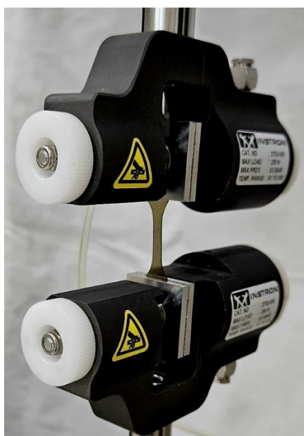
Figura 4.11 - Vista das garras pneumáticas e corpo de prova utilizadas no ensaio de tração.
