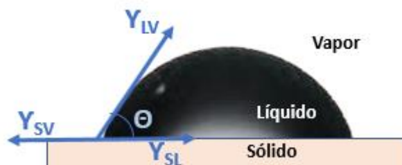
Figura 4.12 - Representação do equilíbrio de forças de um líquido em contato com um sólido, onde \theta é a medida do ângulo e \gamma_{LV} , \gamma_{SV} e \gamma_{SL} representam as energias da interface líquido-vapor, sólido-vapor e sólido-líquido, respectivamente.
