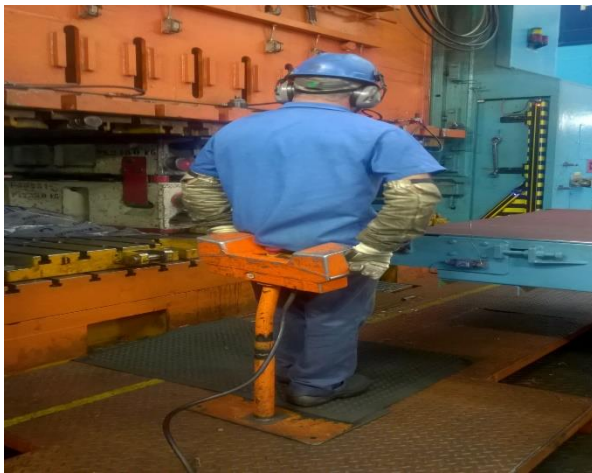
Figura 7: Adaptação do tapete antifadiga ao posto de trabalho. Figura da autora.
