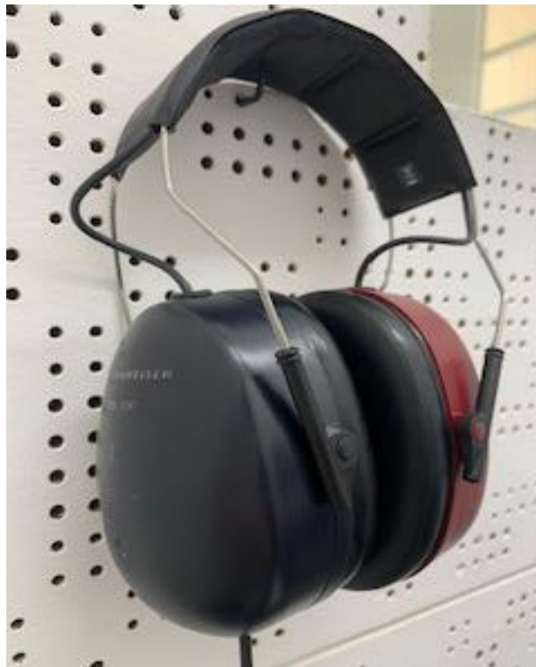
Figura 7- Fone de ouvido audiométrico HDA 200 projetados para testes estendidos de alta frequência. FONTE: autor
