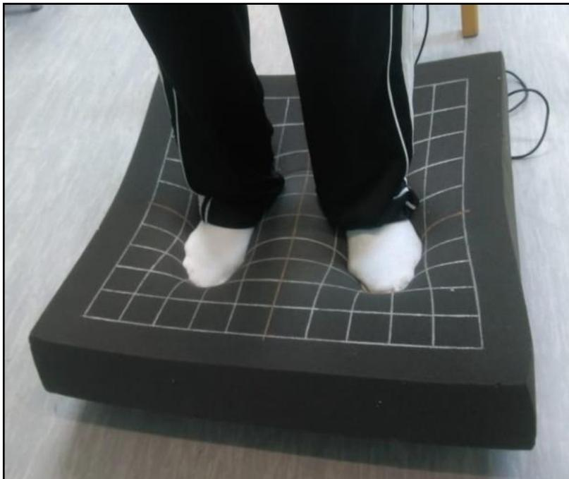
**Figura 7. Posição base natural com espuma sobre a plataforma de força *AMTI*®.** Fonte: Autoria própria.
