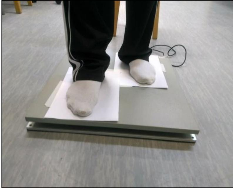
**Figura 8. Posição semi tandem sem espuma sobre a plataforma de força *AMTI*®.** Fonte: Autoria própria.
