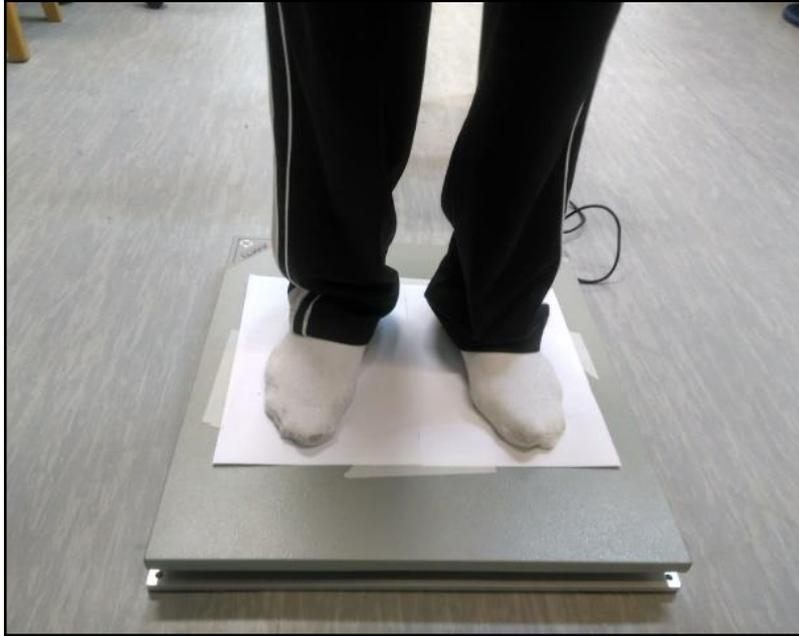
**Figura 6. Posição base natural sem espuma sobre a plataforma de força *AMTI*®.** Fonte: Autoria própria.
