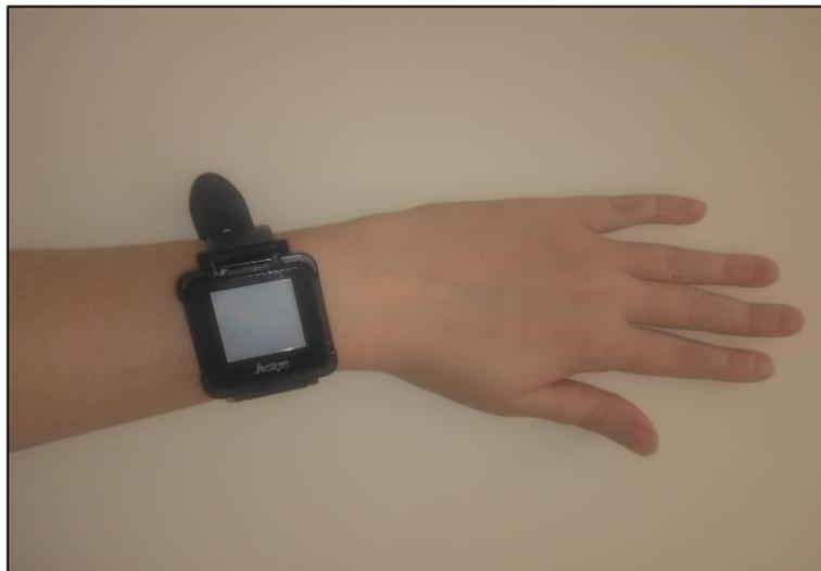
**Figura 3. Acelerômetro Actigraph modelo GT9X Link.** Fonte: Autoria própria.
