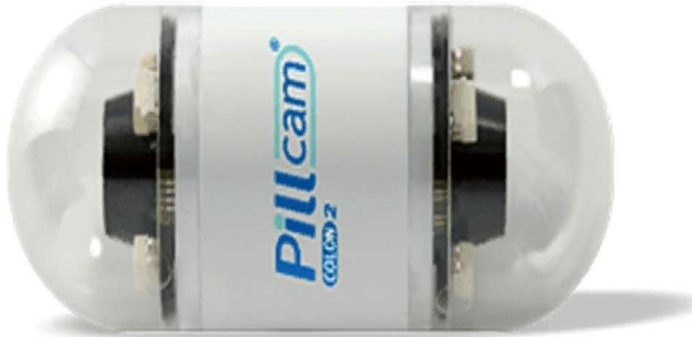
Figura 2 - Cápsula de colón com câmeras de vídeo em cada extremidade
