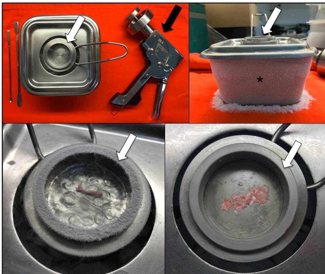
Figura 12. Dispositivo composto por um reservatório metálico inferior maior (asterisco) onde é colocado gelo seco, acoplado a um reservatório metálico superior menor (seta branca) onde é obtido o homogenato ósseo femoral através de disparos manuais com uma pistola específica (seta preta).
