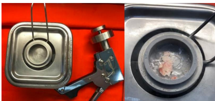
Figura 6. Pulverização do tecido ósseo. Equipamento produzido sob medida utilizado para extração do tecido em baixas temperaturas (-80°C). A pistola realiza uma pressão sob o tecido em nitrogênio líquido e
