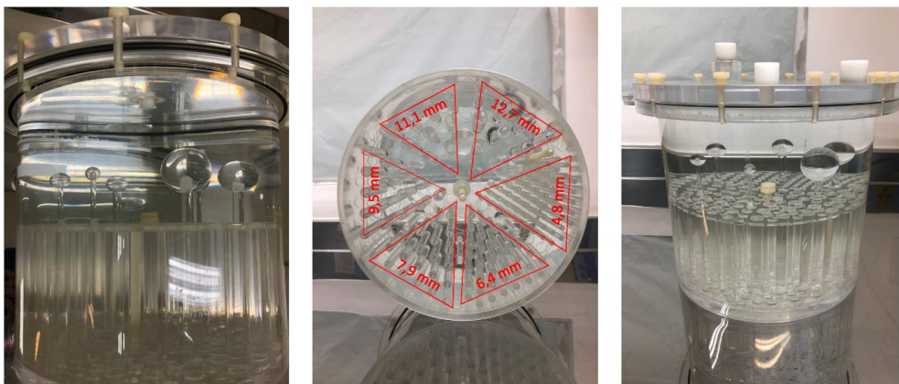
Figura 11. Jaszczak Phantom utilizado no experimento. A imagem central mostra a região em que há “fatias de pizza”.
