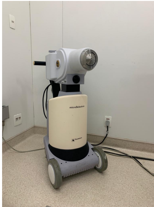
Figura 7: Equipamento de braquiterapia de alta taxa de dose microSelectron-HDR (Nucletron Elekta Company ® ) do ICESP, com 18 canais de tratamento e os conectores acoplados no cabeçote. Fonte: Arquivo Pessoal.
