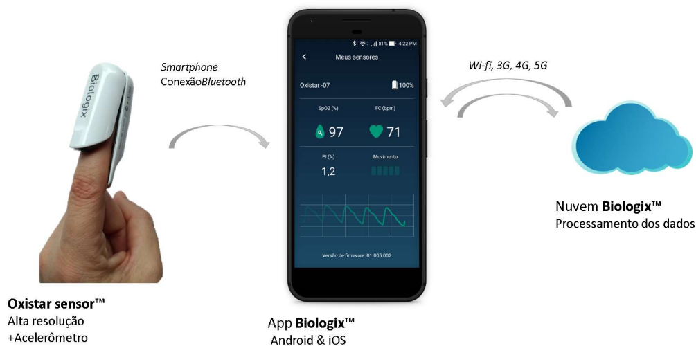
Figura 6 – Sistema de Monitorização Digital por Oximetria (MDO) composto por sensor “Oxistar”, aplicativo de smartphone Biologix e algoritmo automatizado em nuvem.
