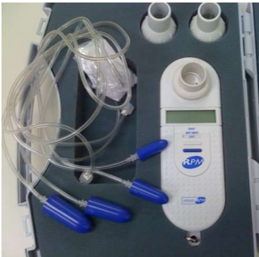
Figura 6. Manovacúmetro digital MicroRPM™ (Care Fusion, UK 232 Ltd.) é capaz de mensurar a P I max, P E max e SNIP.
