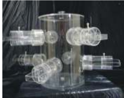
Figura 2. Câmara de Inalação onde os animais foram coletivamente expostos à fumaça de cigarro
