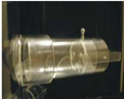
Figura 3. Câmara de exposição onde os animais eram posicionados individualmente antes de estar conectados à Câmara de Inalação
