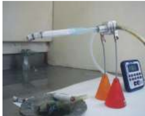
Figura 4. Sistema Venturi com cigarro adaptado a um dos orifícios
