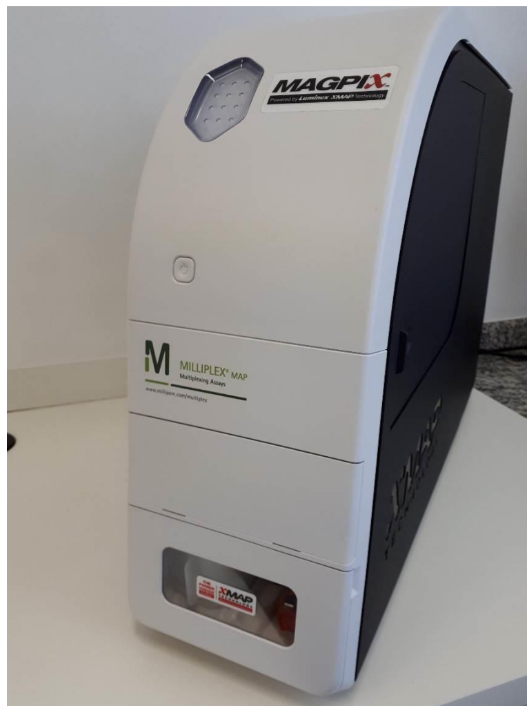
Figura 12 - Aparelho Magpix®, que utiliza a tecnologia xMAP® para leitura de microesferas
