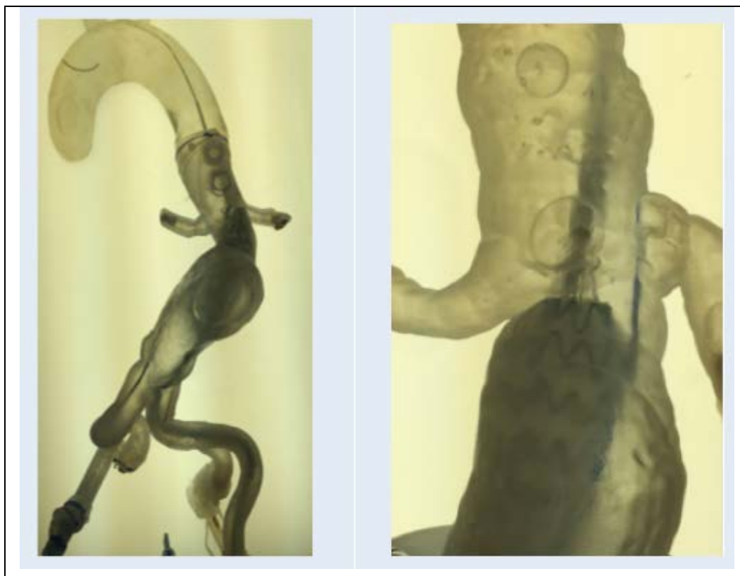
Figura 18 - Molde produzido com Material 2 (Vero Clear)
