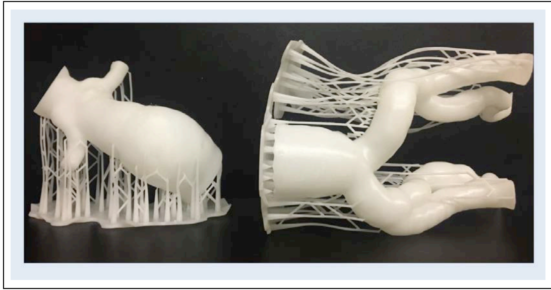
Figura 11 - Pilares produzidos para sustentar um molde, impresso em duas partes, utilizando resina opaca, em teste da impressora Form 1+
