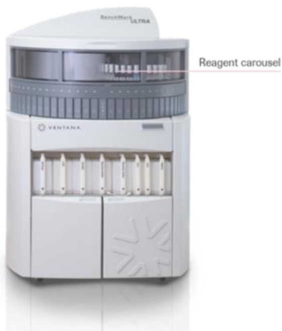
Figura 2 - BenchMark Ultra, Ventana® (Roche) utilizado para realizar os testes de ligação com receptores
