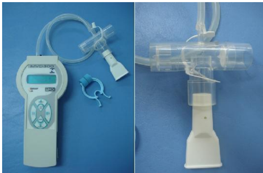
Figura 7. Manovacômetro digital e válvula unidirecional, utilizados para medida das pressões respiratórias.
