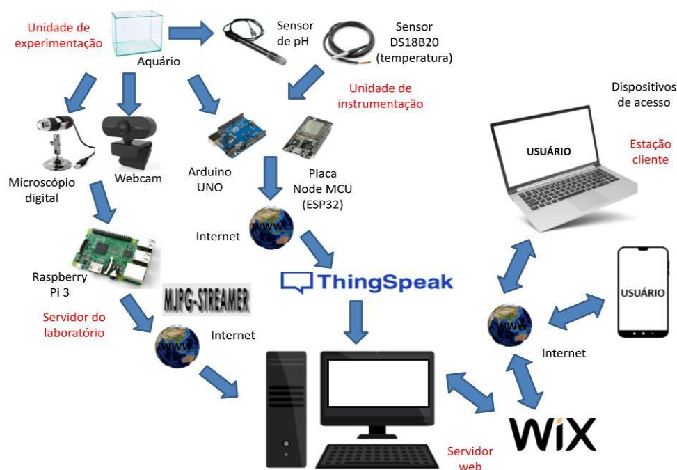
Figura 8 - Arquitetura do laboratório remoto “água da represa Billings”.
