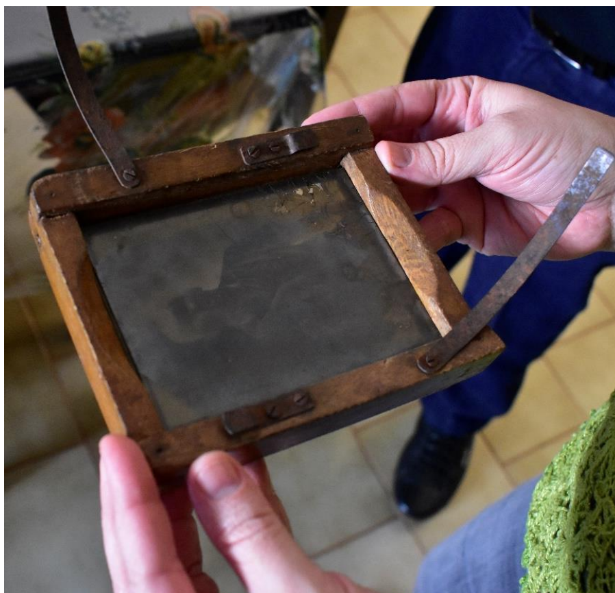
Figura 54 – Impressora manual – caixilho de madeira adaptado para receber o negativo de vidro, já revelado, em contato com papel fotossensível, para posterior exposição à luminosidade natural.
