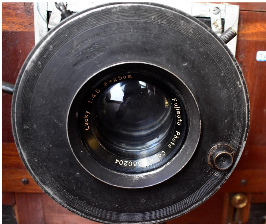
Figura 50 – Detalhe da lente e do diafragma da câmera atelier.
