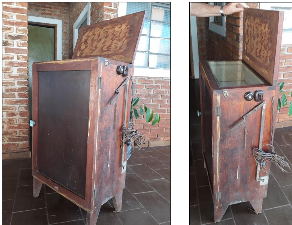
Figura 46 – Apresentação externa da fotocopiadora – vista frontal e lateral. No detalhe é possível observar a alavanca que acionava a abertura e o fechamento da janela presente na face posterior do equipamento. Também é possível observar a fiação adaptada posteriormente para indução da sensibilização por energia elétrica.
