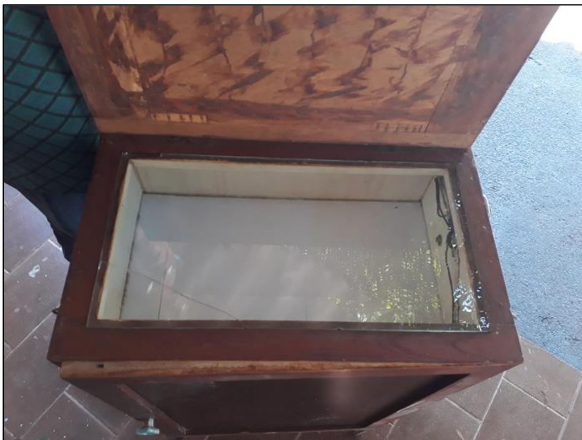
Figura 45 – Fotocopiadora vista de cima. Em destaque a superfície sob a qual o documento a ser copiado deveria repousar com a face a em contato com a lâmina de vidro.
