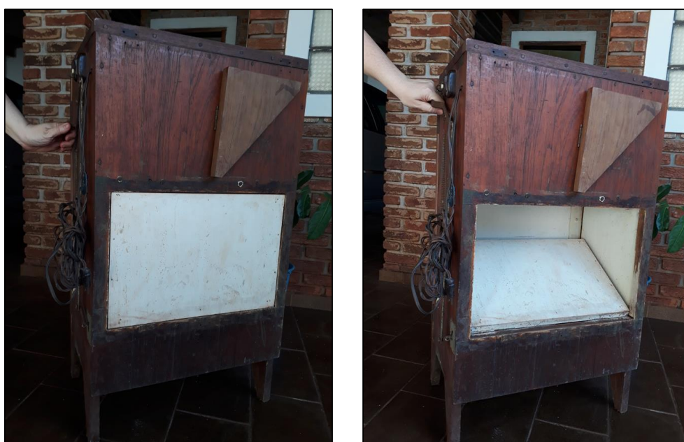
Figura 47 – Vista posterior da fotocopiadora com a janela fechada e acionada. Quando aberta essa janela permitia a entrada da luminosidade solar que sensibilizava o papel fotográfico.
