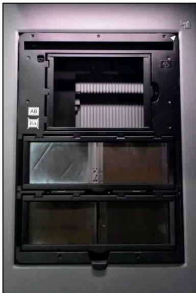
Figura 24 – Digitalização de negativo de médio formato.
