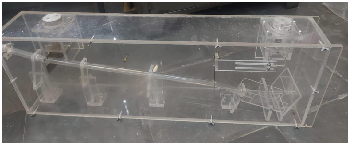
Figura 6. Caixa Experimental 3 planejada em material acrílico, com dimensões de 100 cm comprimento x 17 cm largura x 33 cm altura. Distância entre botões: 72 cm; distância do 1º botão para a saída de alimento: 83 cm; distância do 2º botão para a saída de alimento: 11 cm.
