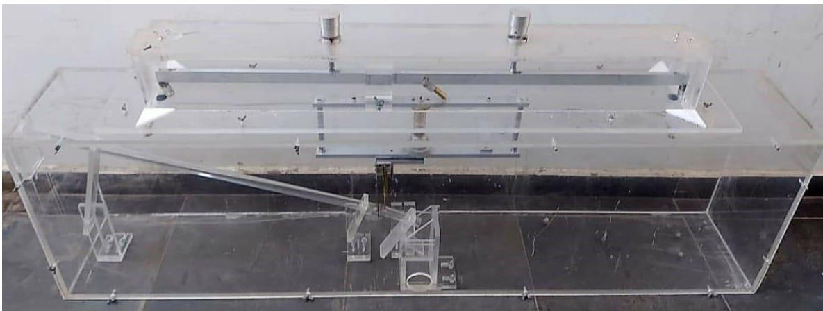
Figura 7. Caixa Experimental 4 construída com material acrílico, com dimensões de 145,5 cm comprimento x 25 cm largura x 41 cm altura. Distância entre botões, na primeira subetapa: 34 cm, ambos equidistantes da saída de alimento.
