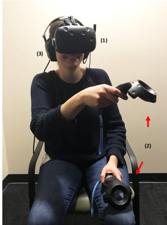
Figura 2. Dispositivos de realidade virtual imersiva: (1) Óculos de RV (HTC Vive); (2) Controles remotos (HTC Vive) & (3) Fones de ouvido.
