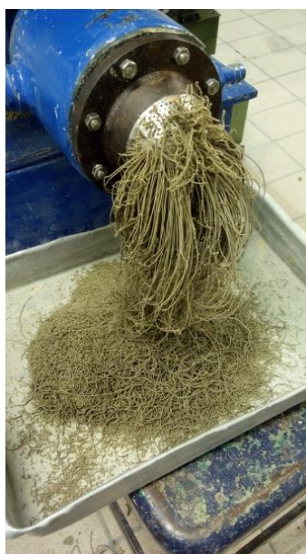
Figura 15 – Bocal da extrusora durante reação de funcionalização de argila.
