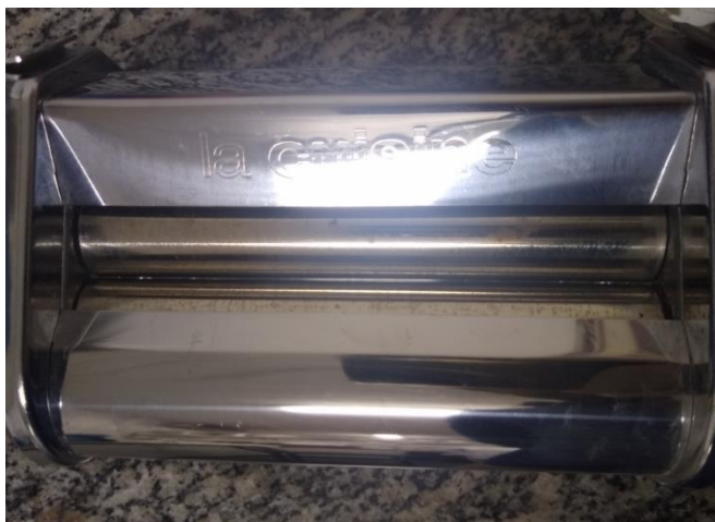
Figura 16- Aparato utilizado para prensar os tecidos (simulação de etapa de prensagem do processo de pad-dry-cure ) após impregnação dos tecidos com os slurries .
