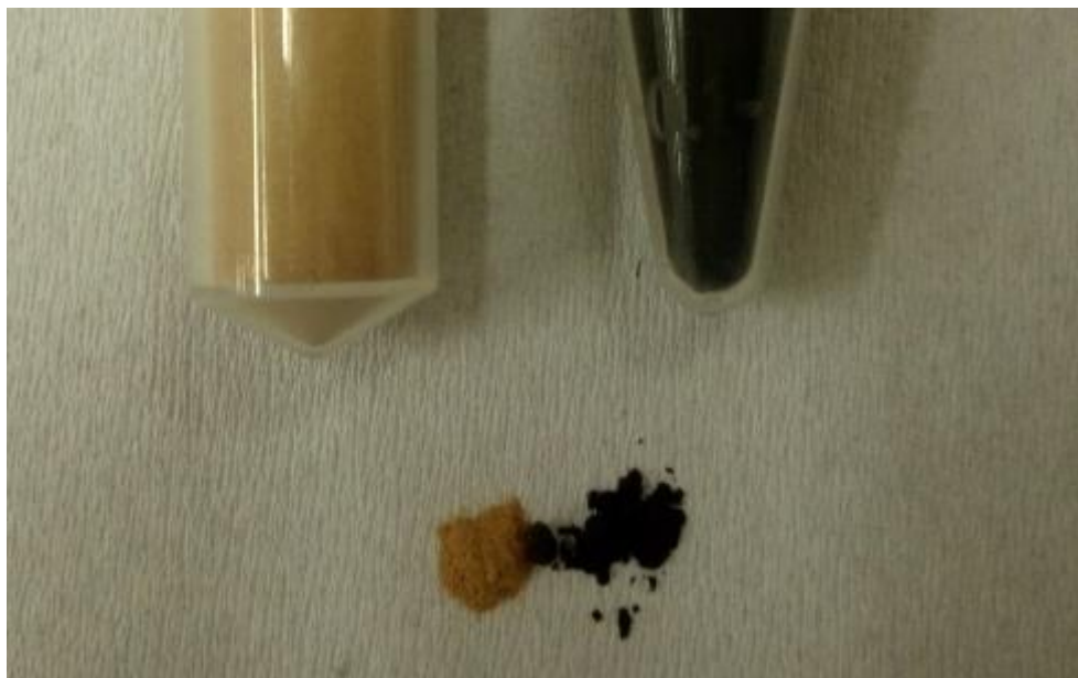
Figura 31 – F1 (à direita) e argila in natura (à esquerda) após calcinação sob 520°C. O mesmo padrão de cor é mantido para as amostras após calcinação sob 800°C.
