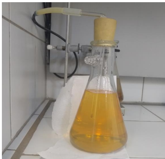
Figura 27 – Solução de reagente de Nessler após borbulhamento do gás recolhido do forno tubular durante a calcinação da amostra F1 a 520°C.
