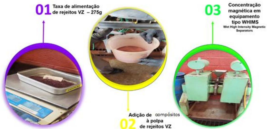
**Figura 9**-Ensaio de concentração magnética com compósitos magnéticos
