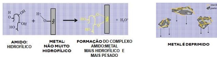
*Figura 5 – Mecanismo de adsorção de amido em um metal*
