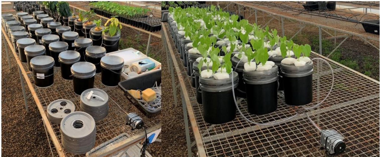
Figura 14. Instalação de experimento utilizando bomba compressora acoplada a um tubo de silicone central, que redistribui o ar nos recipientes através de tubos individuais. A conexão dos tubos é feita através de agulhas.
