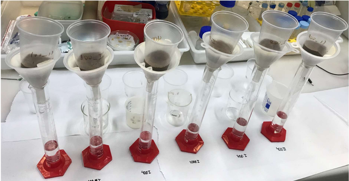
Figura 6 - Aparato montado para realização dos ensaios de capacidade de campo dos solos com adição dos polímeros testados.
