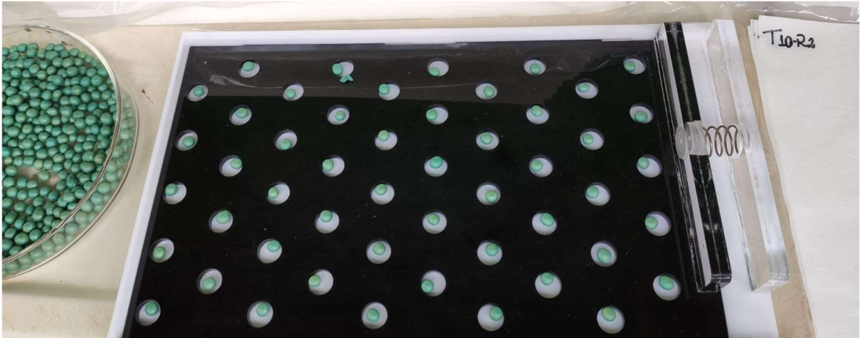
Figura 14 - Aparato posicionado sobre o papel Germitest de modo a permitir o posicionamento ideal das sementes de soja sobre o substrato.
