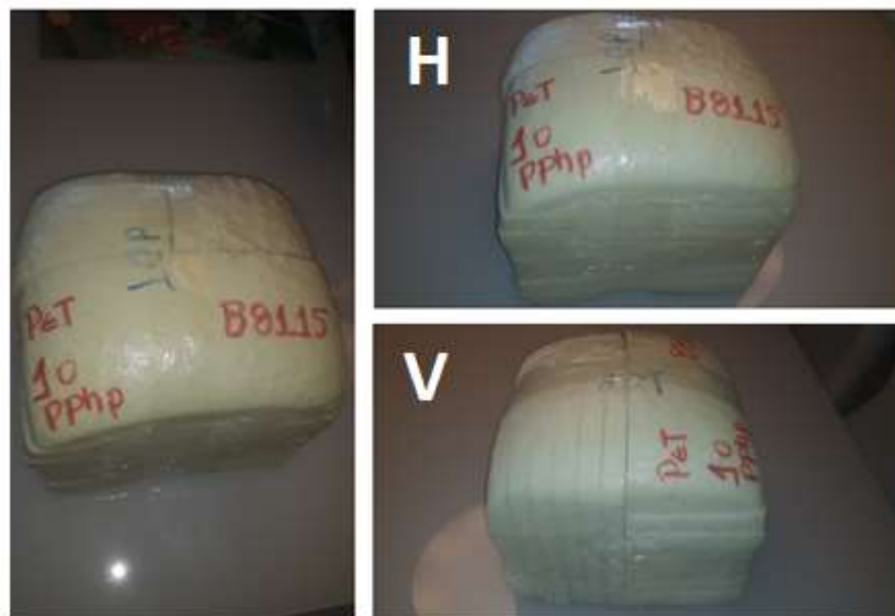
Figura 22 – Um bloco de espuma de PU de 25x25x25 cm contendo 10% de PET micronizado fluorescente, ilustrando o fatiamento do bloco de espuma nos sentidos horizontal (H) e vertical (V) para obter os corpos de prova e avaliar a distribuição espacial da fluorescência.
