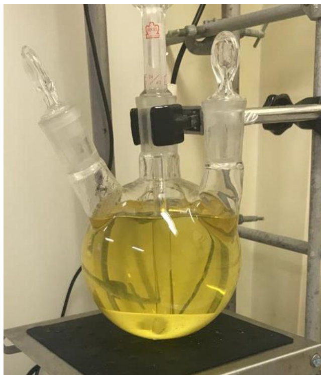
Figura 4 – Reator de vidro com o Pré-polímero
