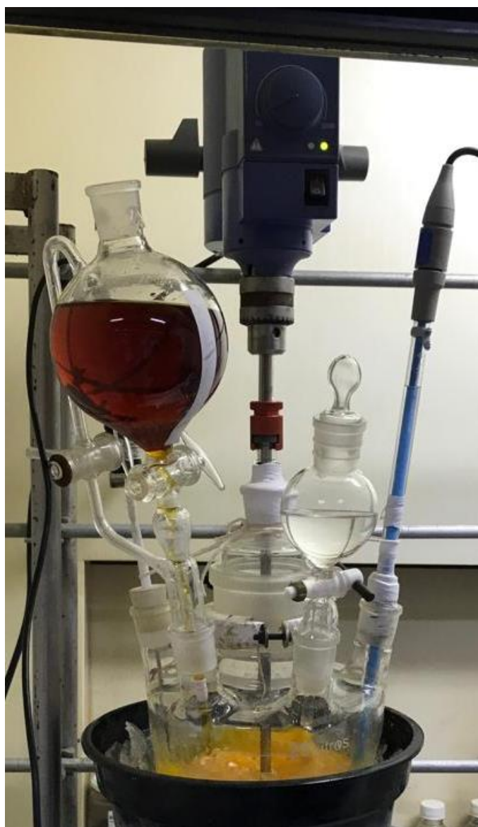
Figura 5 – Reação do pré-polímero com epícloridrina.
