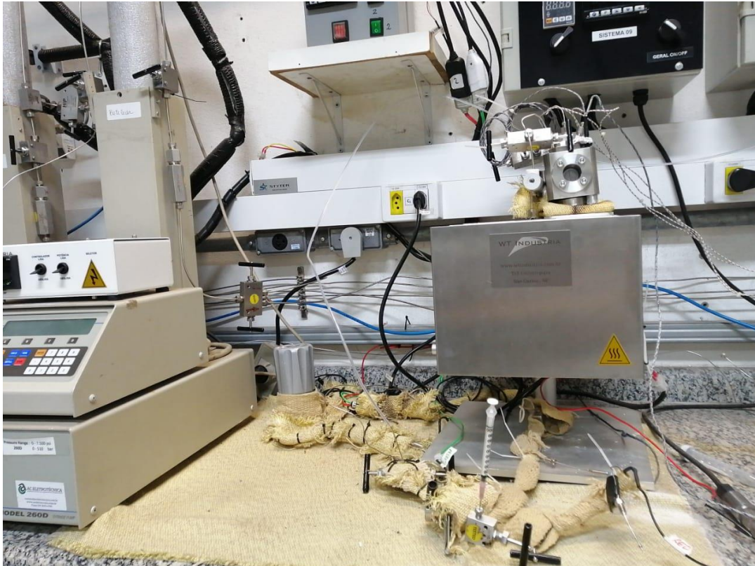
Figura 33. Sistema reacional de fluxo supercrítico
