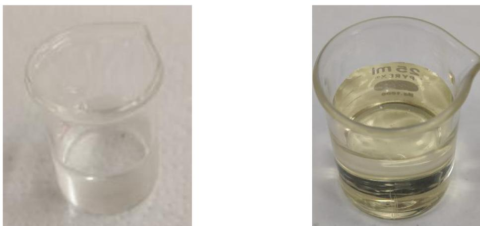
**Figura 23:** Fotos do glicoxal puro e com impurezas utilizados nesse trabalho. À esquerda, reagente sem indício de degradação (glicoxal 2, Sigma-Aldrich recém-aberto) e à direita, reagente com indício de degradação (glicoxal 1, Dinâmica depois de 17 meses).
