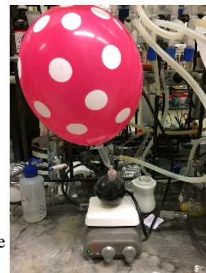
Figura 84. Sistema reacional de hidrogenação catalítica com Pd/C e H 2 para obtenção do produto 308.
