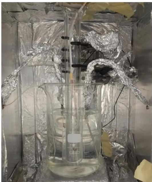
Imagem 14: Visão interna do reator fotoquímico
