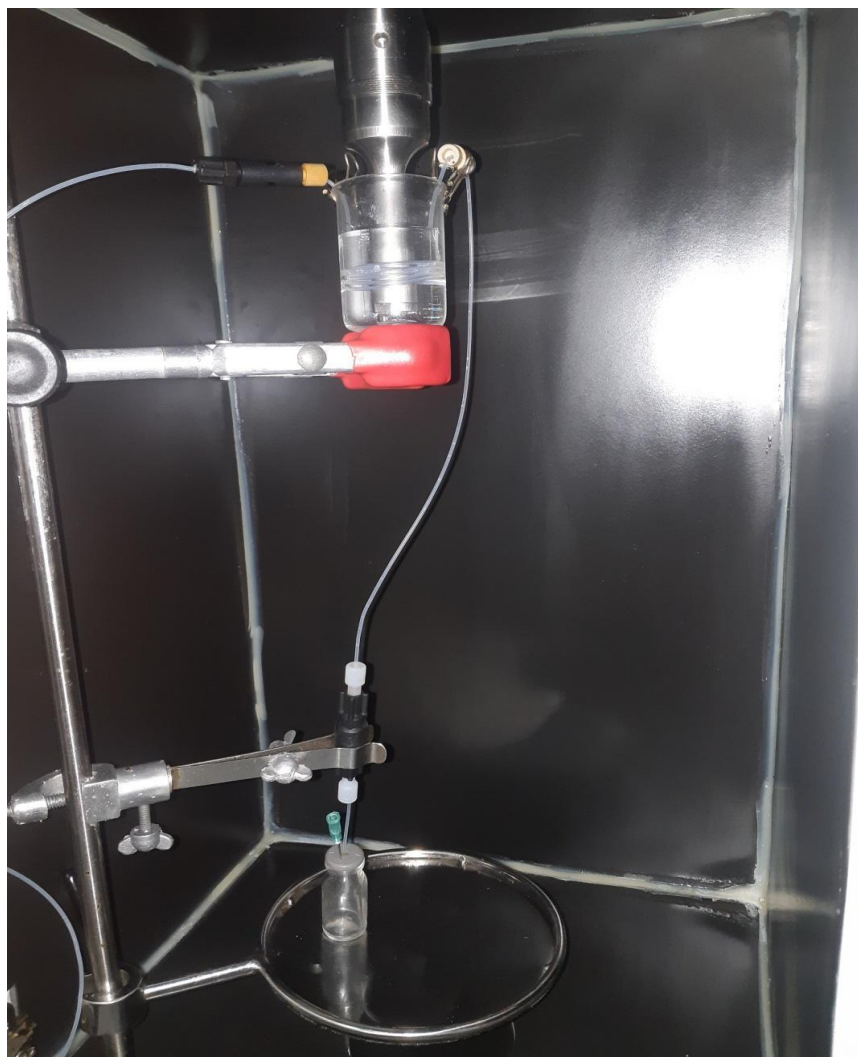
Imagem 18: Reator ultrassônico em fluxo contínuo montado
