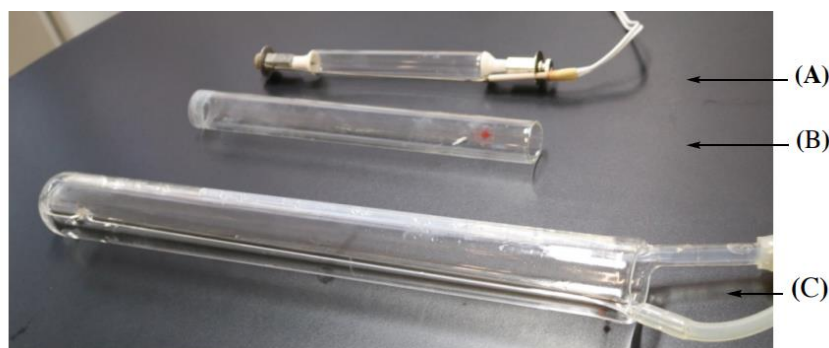
Imagem 11: A) Lâmpada UV (média pressão, vapor de mercúrio, 450 W, B) Filtro de absorção (Pyrex), C) Poço de imersão de quartzo (Ace-Thred connection) todos obtidos da Ace Glass INC
