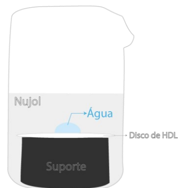
Figura A4| Medidas de ângulo de contato entre três fases para os materiais sintetizados. A. HDL_flash_Cl; B. HDL_flash_NBxn; C. Esquema representando como a medida foi realizada; o suporte foi colocado para facilitar a visualização da gotícula de água adicionada.
