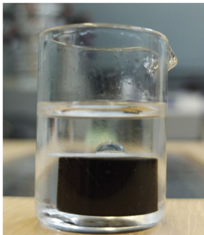
Figura A4| Medidas de ângulo de contato entre três fases para os materiais sintetizados. A. HDL_flash_Cl; B. HDL_flash_NBxn; C. Esquema representando como a medida foi realizada; o suporte foi colocado para facilitar a visualização da gotícula de água adicionada.
