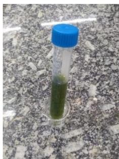
Figura 3.4 – Eletrólito de corrida (solução de LiCl a  $10,0 \text{ mmol}\cdot\text{L}^{-1}$  com pH igual a  $6,86 \pm 0,04$ ) utilizado para determinação do tempo de vida útil no mecanismo de eletrólise separada adotado no BeerBox.
