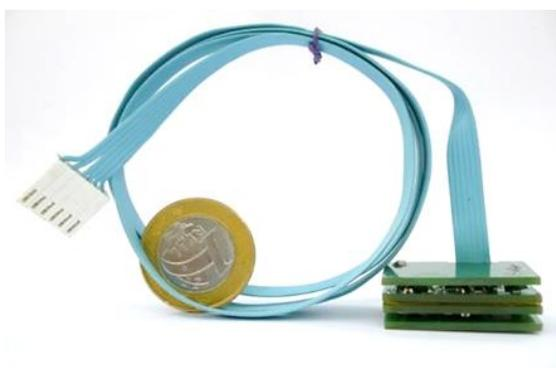
Figura 1.5 – Um  $C^4D$  ao lado de uma moeda de R\$1. A moeda possui 27 mm de diâmetro.
