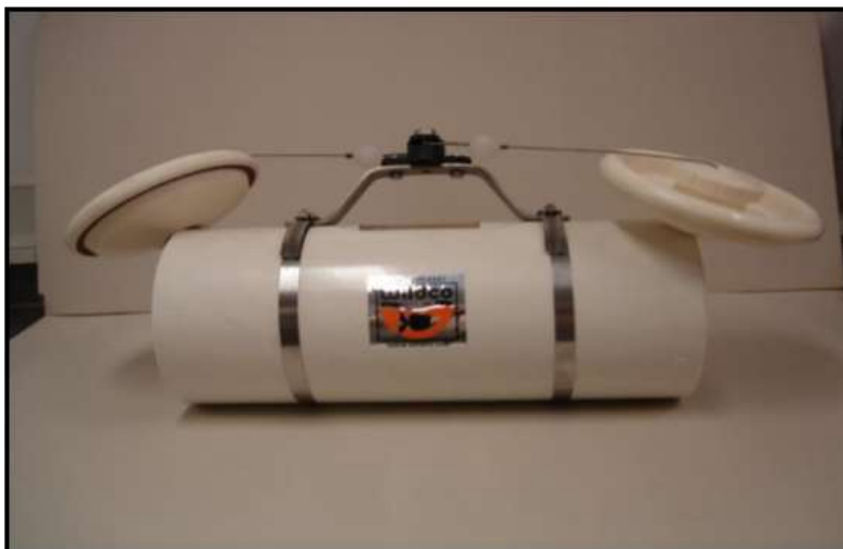
Figura 5.9. Garrafa de Van Dorn de descida horizontal
