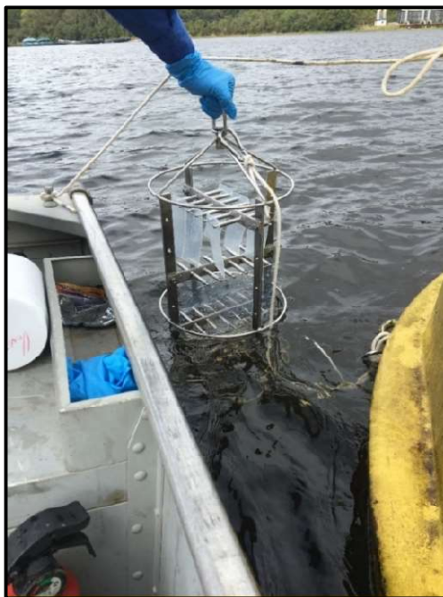
Figura 5.7. Instalação do amostrador passivo com os três tipos de membranas no ponto 1
