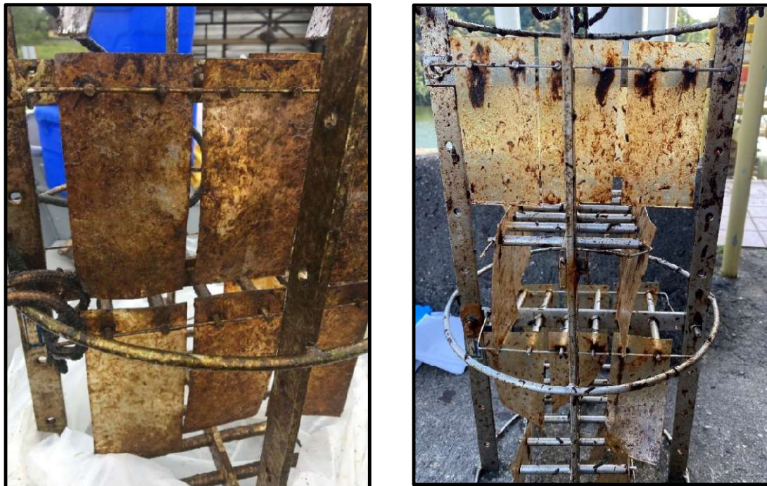
Figura 6.20. Aspecto das membranas após 90 dias de exposição no ponto 1 (esquerda), e ponto 2 (direita)
