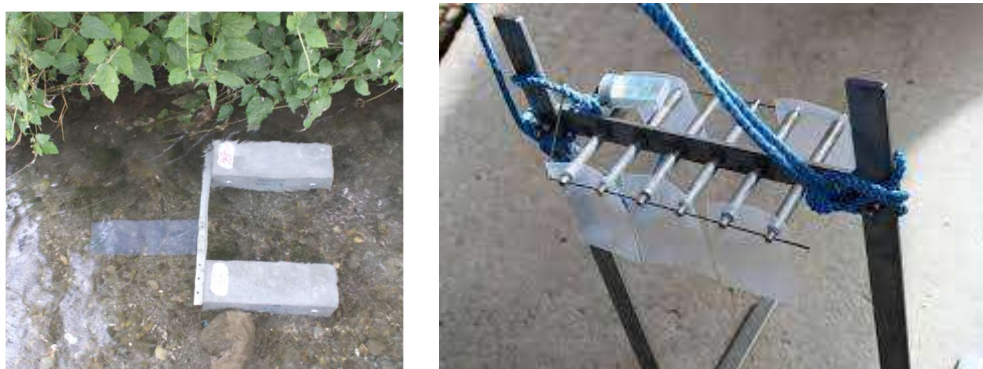
Figura 2.8. Membranas de silicone montadas para exposição em campo
