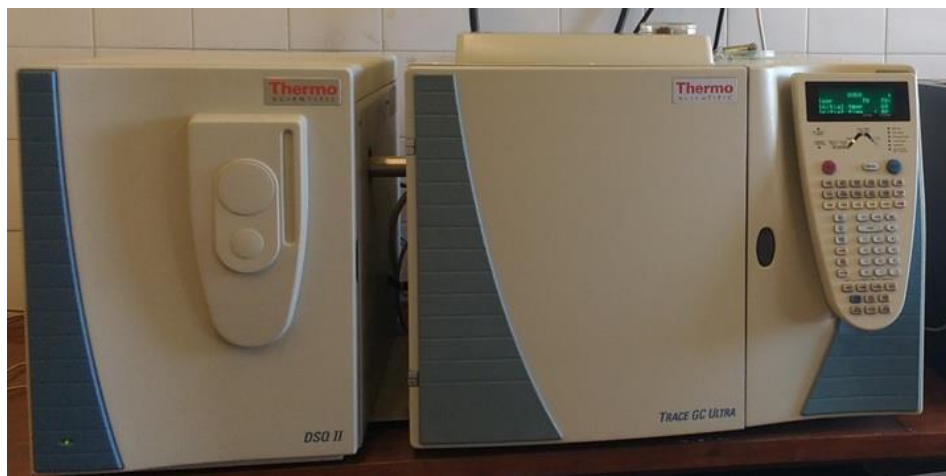
Figura 3.5 - CG/EM utilizado para determinação dos compostos alifáticos para as amostras de 2015 a 2017, Universidade de Aveiro. (Acervo pessoal)
