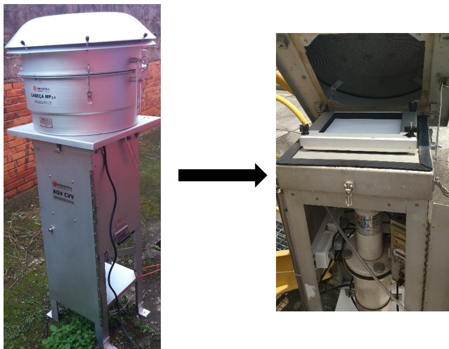
Figura 1.7 - a) Imagens externas e internas do amostrador de partículas totais suspensas (PTS) utilizados nos anos de 2015 e 2016; b) Imagens do amostrador de partículas finas (MP2.5) utilizado em 2017 e 2018. (Acervo pessoal).
