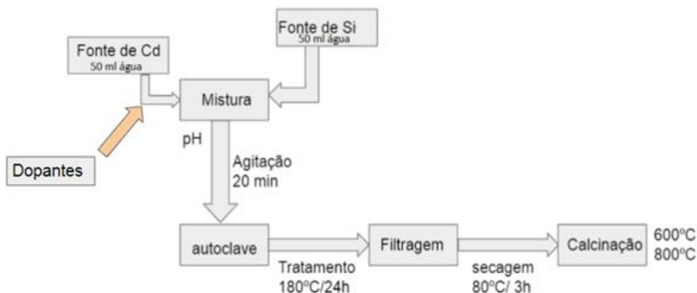
Figura 23. Esquema do procedimento experimental para o método Hidrotermal.
