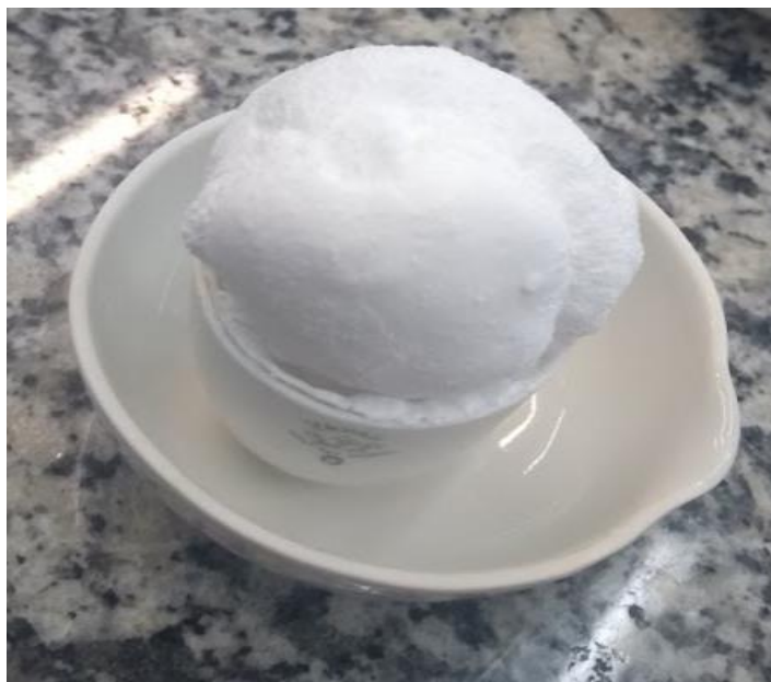
Figura 27. Amostra produzida a partir do acetato de cádmio (CdAc), estequiometria 2:1 a 800°C
