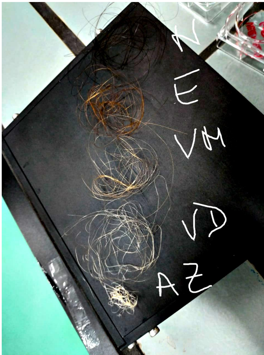
Figura 57. Fotos de fios naturais de tom 4, embebidos em solução de peróxido de hidrogênio ( 2\text{mol.L}^{-1} ) por 1 hora e mantidos no escuro (N) irradiados com luz azul (AZ), verde (VD), vermelho (VM).
