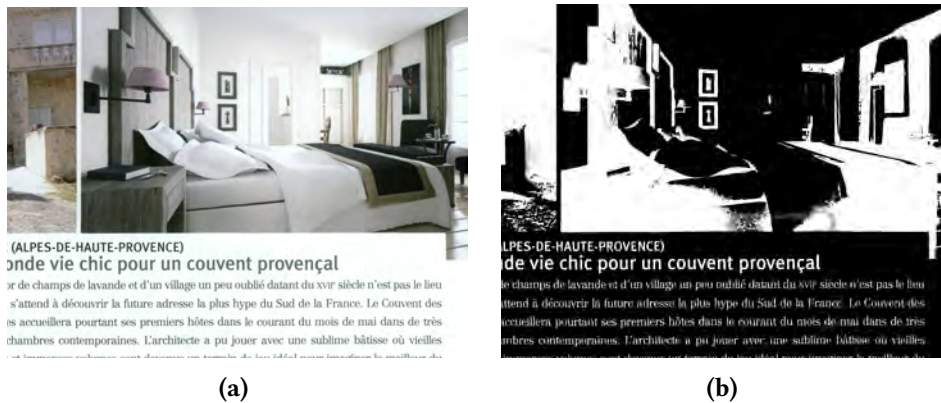
Figura 5.18: Recorte da imagem do documento original (a) e sua versão binarizada (b), em que a binarização "apaga" parte da figura.
