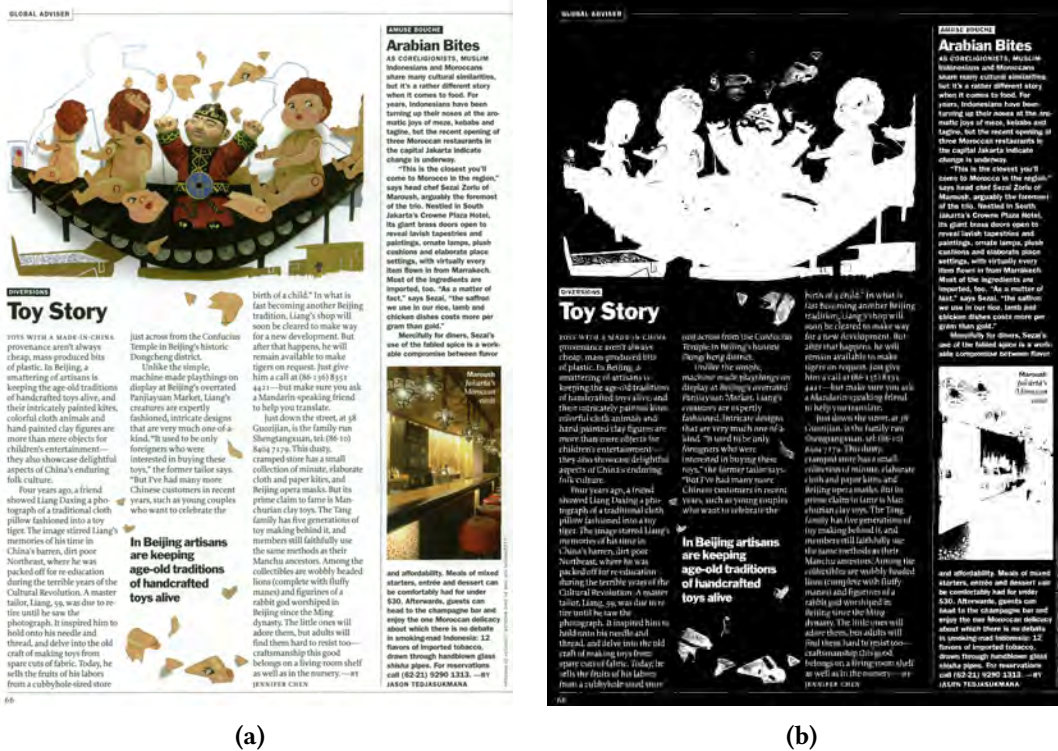
Figura 3.3: Exemplo do resultado da aplicação da binarização de uma imagem de documento, utilizando o limiar de Otsu. (a) Imagem original em RGB. (b) Imagem binarizada.
