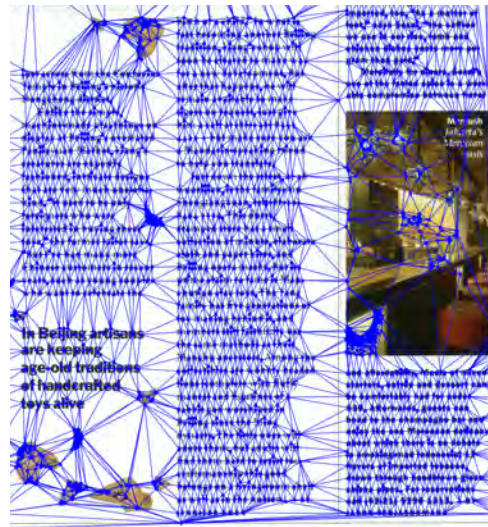
Figura 3.5: Ilustração do grafo construído a partir da triangulação de Delaunay para um recorte da imagem do documento da figura 3.4. Os vértices estão localizados nos centroides de cada componente conexa.
