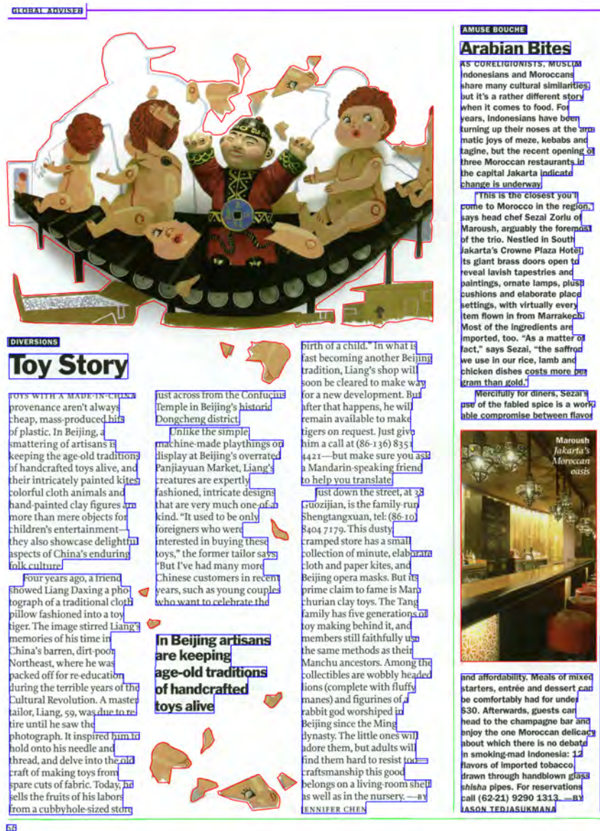
Figura 3.9: Ilustração dos polígonos envoltórios dos componentes de página da imagem do documento da figura 3.7. Cada cor representa um tipo de componente.
