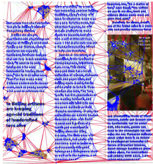
Figura 3.6: Ilustração das arestas a serem removidas (em vermelho) no recorte da imagem do documento da figura 3.5 de forma que os subgrafos resultantes (em azul) correspondam aos componentes de página.
