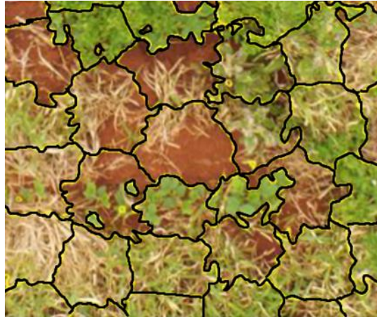
Figura 3.7 – Imagem parcial segmentada usando o algoritmo SLIC [FERREIRA et al. 2017].
