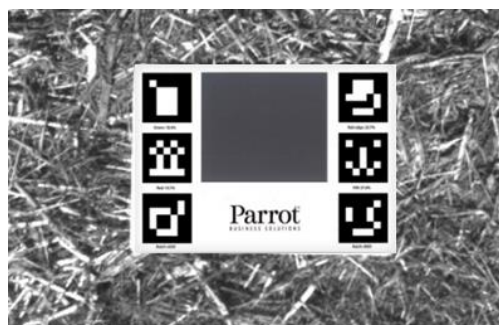
Figura 4.39 – Alvo de calibração radiométrica.
