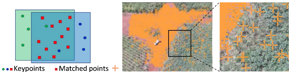
Figura 4.17 – Sobreposição de imagens para extração de keypoints correspondentes em múltiplas imagens e pontos-chave encontrados em uma imagem RGB.
