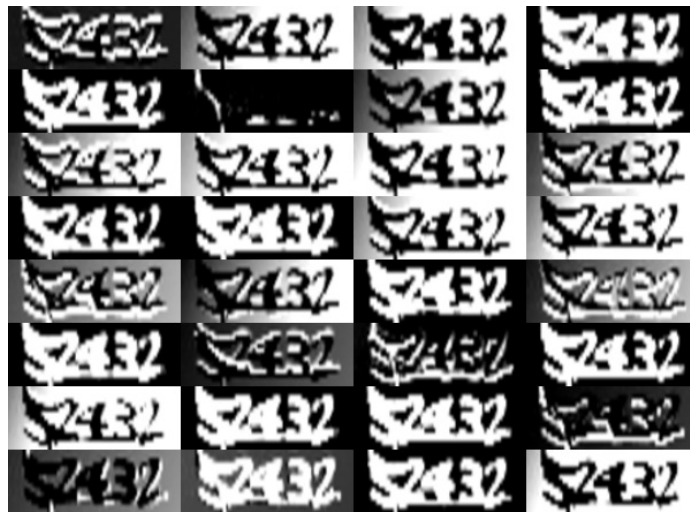
Figura 2.11: Resultado da aplicação da primeira convolução à imagem e da operação de max pooling
