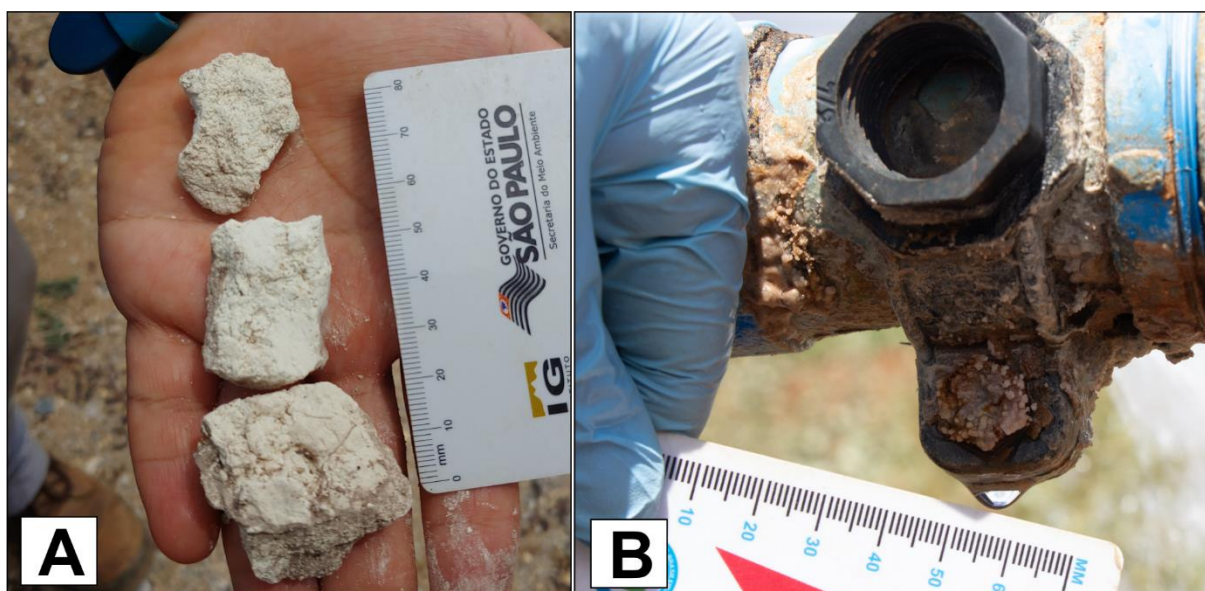
Figura 4.19 - Crostas precipitadas em poços. A: Crosta com enxofre nativo coletado no poço do 'Bocão', Povoado de Quixaba, Iraquara. B: Crostas de gipsita no Poço 2 da Fazenda Canafístula, Povoado Lagoa do Zeca, Canarana.
