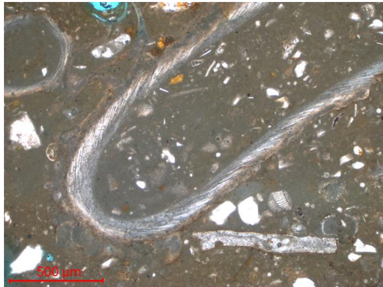
Figura 42 – Tubo de serpulídeo em meio a matriz micrítica com intra e extraclastos arenosos, encontrado em amostra de Guarapari (ES). Fotomicrografia ao microscópio petrográfico com polarizadores descruzados.
