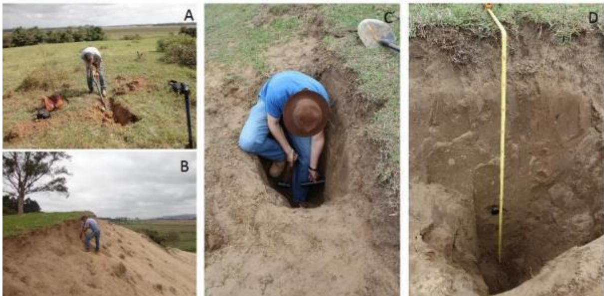
Figura 4.1. Dois tipos de amostragem: em trincheira, no topo da feição morfodepositiva (A, C e D) e em corte vertical, aproveitando exposição preexistente (B). Notar processo de cravação de tubo amostrador para datação LOE (C) e uso de trena para medir a profundidade do tubo e as espessuras das fácies e/ou horizontes de solo (D).
