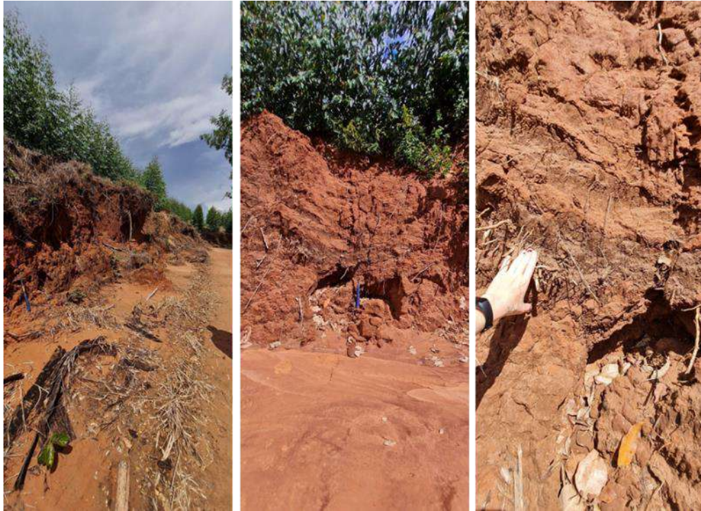
Figura 49 - Afloramento de solos residuais de arenitos eólicos da Fm. Botucatu em estrada de acesso local sentido córrego do Alambari (ponto 274; UTM 7460831.36 N/ 771030.62 E).
