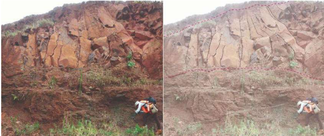
Figura 28 – Porção intermediária do corte onde observado contato entre dois derrames, identificado por camada de até 1m de espessura vesiculada, delimitada por tracejado magenta, alterada em muitas porções a argila siltosa de cor marrom escura, sob horizonte de basalto em maciço fraturado (ponto 77; UTM 7460266.77 N/ 769472.651 E).
