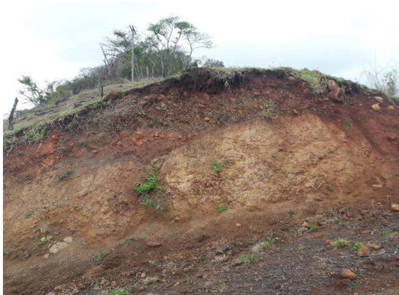
Figura 41 - Contato basalto sobre arenito apresenta contato irregular sobre arenito – contato em estrada de acesso às fazendas pelo topo da serra (ponto 201; UTM 7462146.14/ 769098.56 E).
