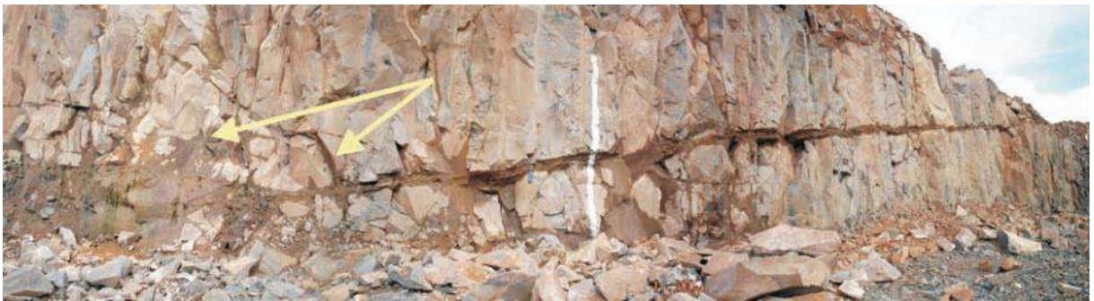
Figura 12 - Junta-falha em corte de basalto com faixa de preenchimento centimétrico argiloso, em destaque pelas setas amarelas; extraído de Sadowski (2012).
