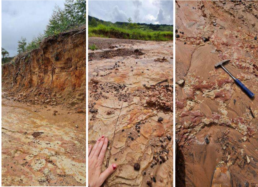
Figura 52 - Fotografias com vista em planta e perspectiva de superfície de camada de arenito Pirambóia com traços de sistema de discontinuidades subverticais, bem como padrões de oxidação/laterização formando manchas avermelhada.
