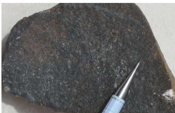
Figura 21 - Amostra de mão de basalto/ microgabro da porção maciça interna aos derrames.
