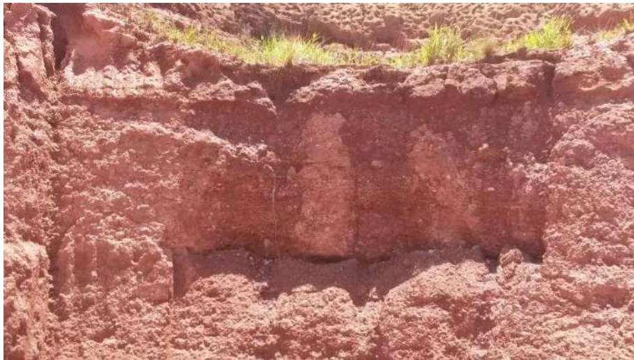
Figura 55 - Topo de derrame corte em rocha km 239, em perfil de alteração de solo de alteração de basalto vesicular vermelho, arenoso, sendo possível a identificação de 'pontos' brancos que correspondem às amígdalas (ponto 2; UTM 7460238.457 N/ 769308.857E).
