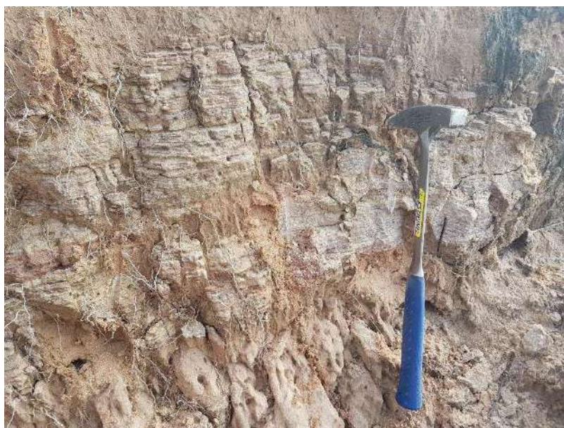
Figura 47- Arenito pouco argiloso esbranquiçado, fino, com estratificação plano paralela e descontinuidades subverticais exposto em cortes ao longo da ferrovia (ponto 127; UTM 7462442.62 N/ 770766.94 E).
