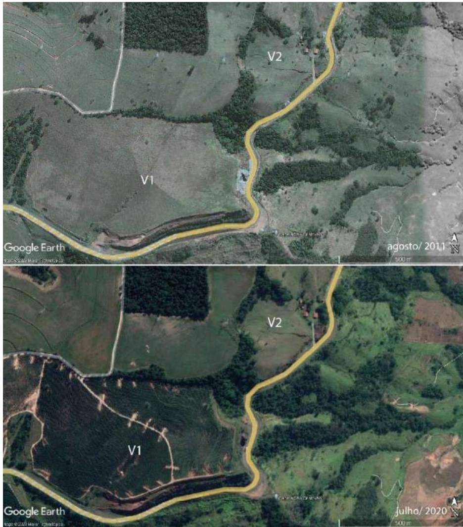
Figura 58 - Expressão das vossorocas V1 e V2 em alinhamentos N45 e N275, respectivamente; regiões de topo de derrames no alto da serra, região dos km 239 e 238 da rodovia SP-300, sobre solo residual vermelho arenoso de basalto vesicular/ amigdaloidal; data das imagens indicadas, obtidas através do software Google Earth .
