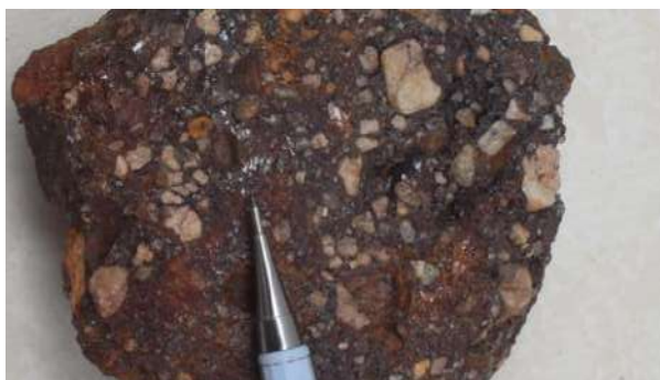
Figura 20 – Amostra de mão de basalto vesicular/ amigdaloidal de topo de derrame.
