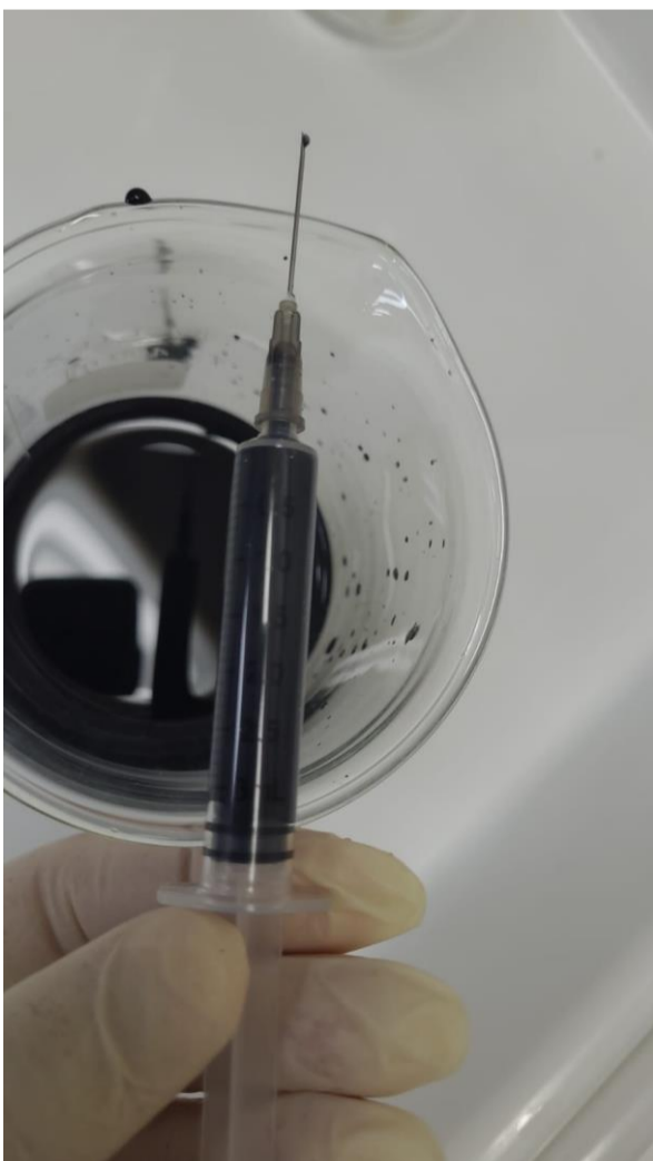
Suspensão preparada, ativada ao longo de 48h em garrafa PET e coletada em seringa para injeção nas portas intermediárias no corpo das colunas SAR e CON.
