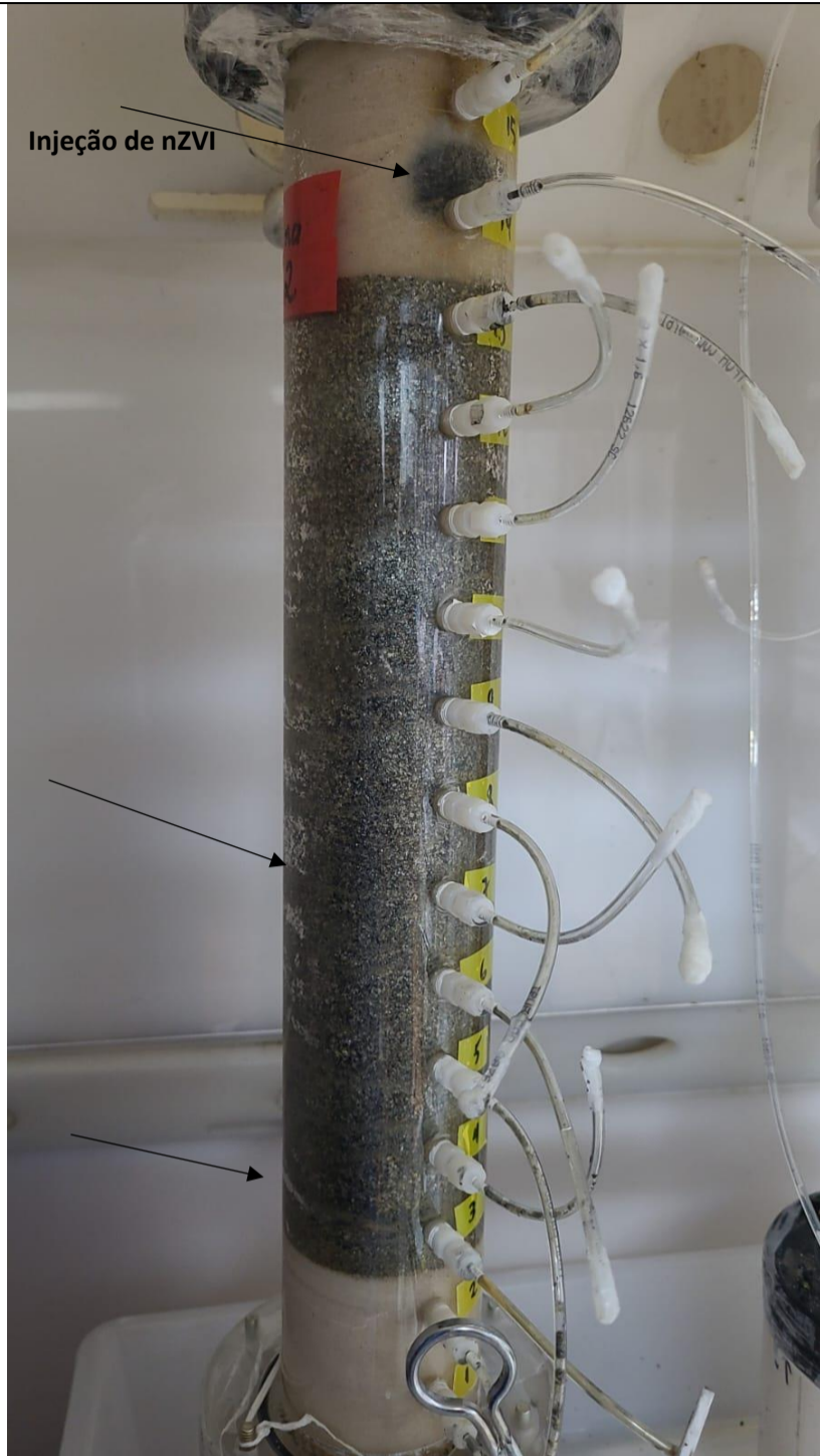
Coluna SAR com injeção em estágio inicial/intermediário. Boa dispersão por planos de fraqueza provavelmente condicionados por minerais micáceos; Destaque para a porção basal, na porta 3, a qual obteve êxito no estabelecimento de boas condições para decloração redutiva
