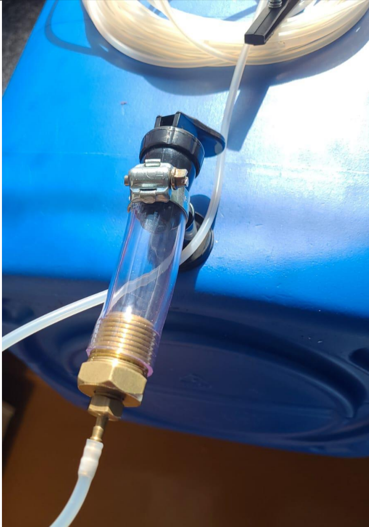
Adaptação de registro com sistema hermético para circulação da água do reservatório principal (entrada das colunas). O dispositivo cria uma câmara e engate de mangueiras de silicone (grau médico) que permite a eliminação de bolhas.
