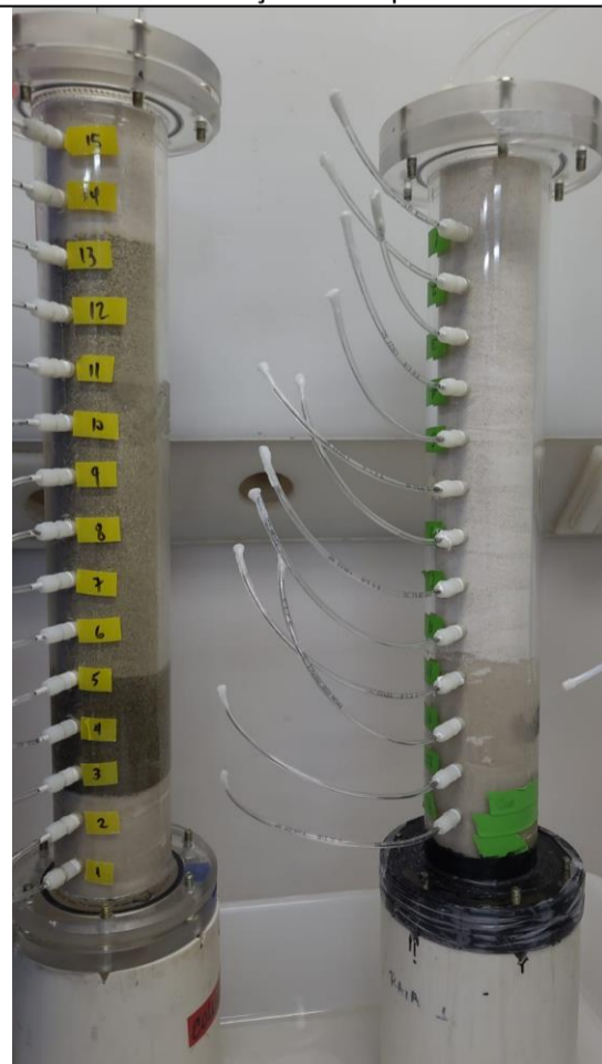
Propagação da frente de saturação até a completa saturação. Inversão das colunas para expulsão e dispersão de eventuais bolhas após completa saturação
