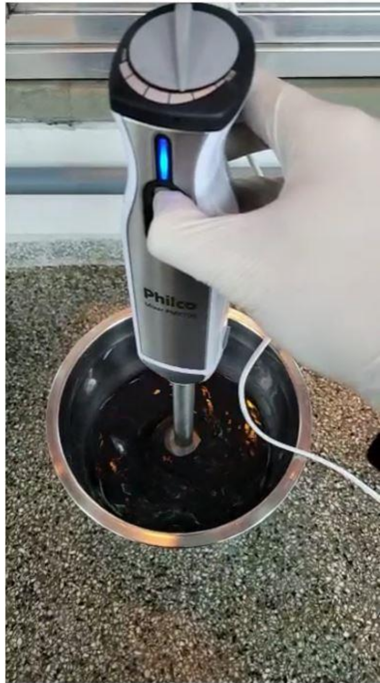
Mistura e ativação por alto cisalhamento com mixer de cozinha em bacia e lâminas de aço inox.
