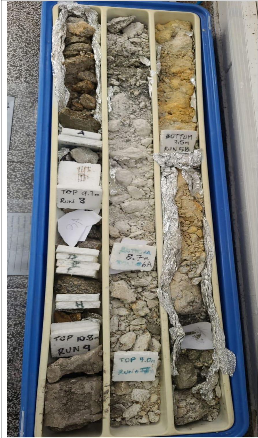
Caixa de testemunhos considerada para preparo de amostras. Materiais utilizados concentrados na calha da esquerda (biotita gnaíse)
