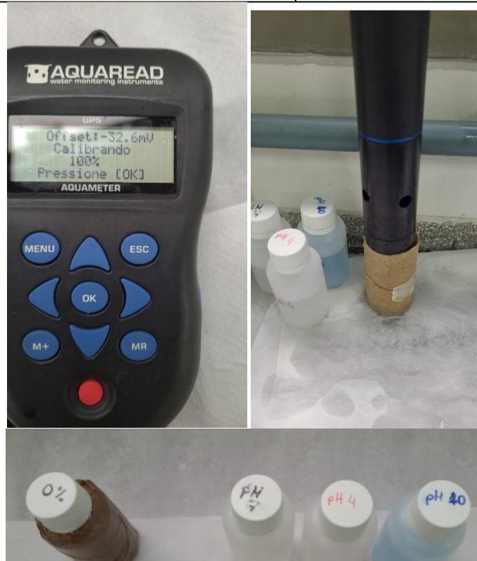
Calibração das sondas do equipamento multiparâmetro AQUAREAD
