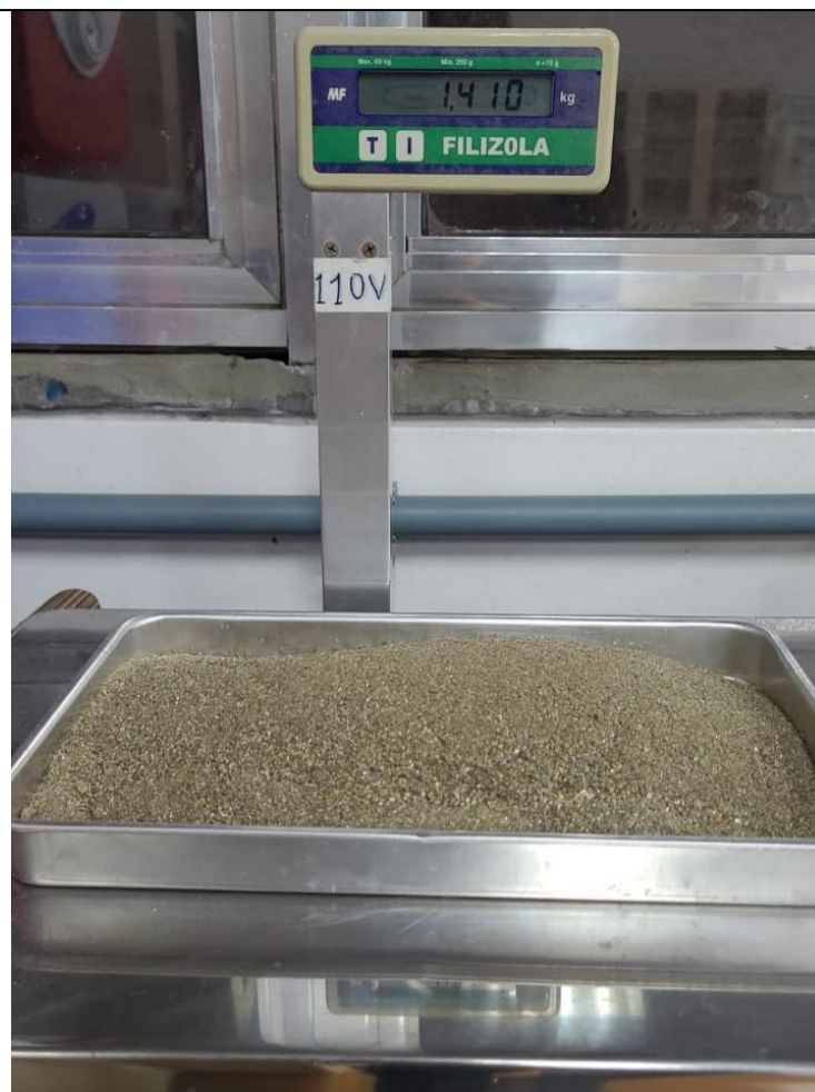
Pesagem do material da coluna SAR para posterior secagem (<50°C)
