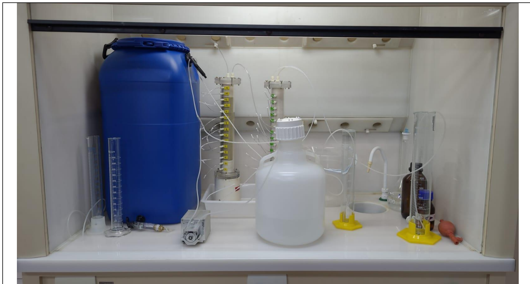
Aparato experimental montado e em fase de testes hidráulicos com água deionizada e solução traçadora para estudo de características hidráulicas (porosidade, vazões operacionais, condutividade hidráulica estimada, tempo de ensaio disponível com relação ao volume coletado em campo)
