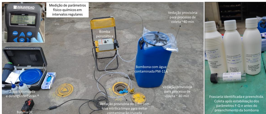
Figura 17 – Procedimento de coleta em campo
