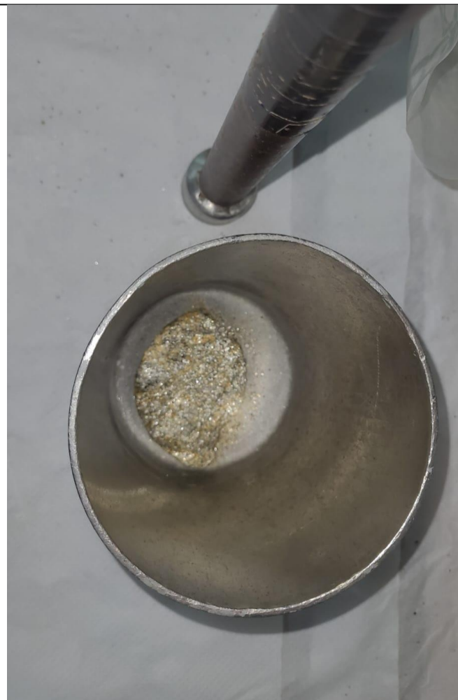
Desagregação mecânica com pilão e peso de aço inox
