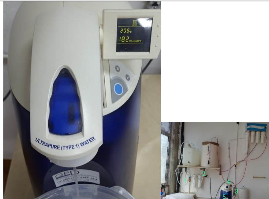
Dispenser de água deionizada utilizado (esquerda), conectado à rede de abastecimento pública (direita).
