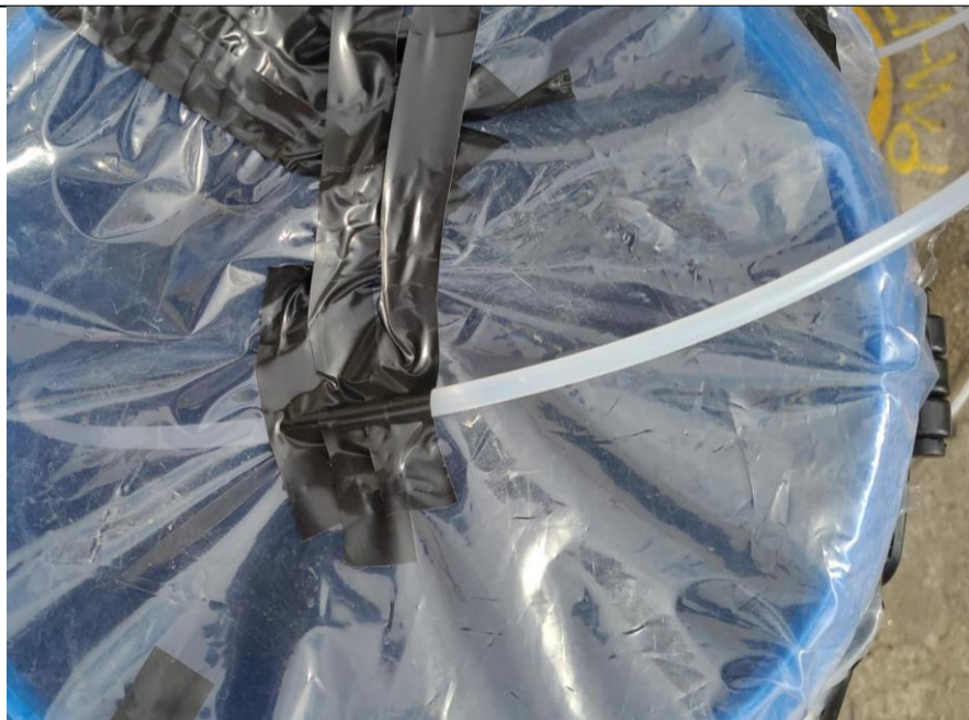
Reservatório hermético destampado para coleta com selo provisório para mitigar perdas de voláteis
