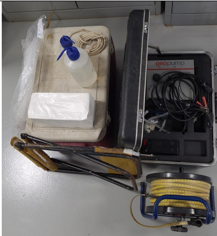
Insumos e equipamentos para coleta do poço PM-11A; Bomba peristáltica operada em vazão mínima para produzir o menor rebaixamento possível e fluxo laminar entre formação e tubo do poço
