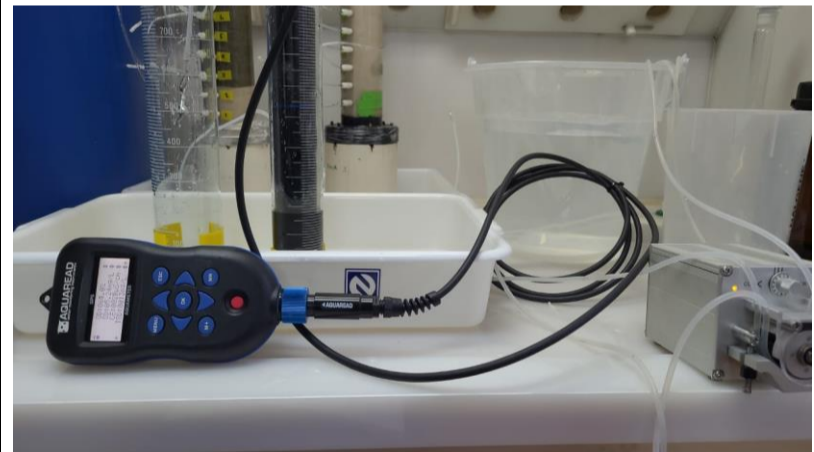
Monitoramento da frente de fluxo da solução traçadora e água de enxágue (deionizada)
