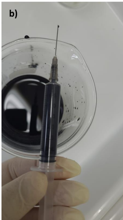
Figura 26 – a) esquema representando eventos de injeção da suspensão de nZVI; b) suspensão preparada, ativada ao longo de 48 horas, em garrafa PET e coletada em seringa para injeção nas portas intermediárias, no corpo das colunas SAR e COM; c) início da injeção de nZVI na coluna CON (esquerda); estágios intermediários da injeção na coluna de controle (direita).
