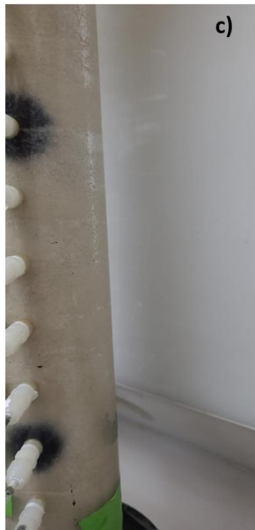
Figura 26 – a) esquema representando eventos de injeção da suspensão de nZVI; b) suspensão preparada, ativada ao longo de 48 horas, em garrafa PET e coletada em seringa para injeção nas portas intermediárias, no corpo das colunas SAR e COM; c) início da injeção de nZVI na coluna CON (esquerda); estágios intermediários da injeção na coluna de controle (direita).
