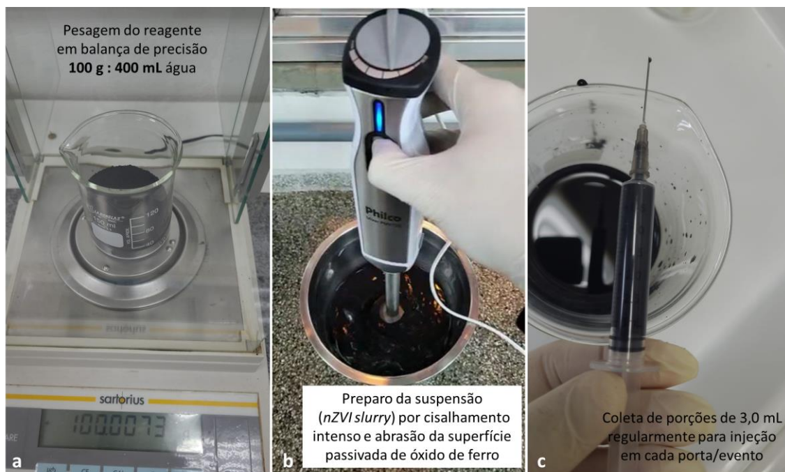
Figura 18 – Procedimento de preparo da suspensão de nZVI, sendo a) pesagem do reagente seco passivado em balança analítica; b) preparo da solução por cisalhamento intenso, por 10 minutos, para abrasão da camada de óxido de ferro e subsequente ativação por 48 horas; c): coleta de volumes fixos, para injeção nas colunas, com seringas e agulhas descartáveis.
