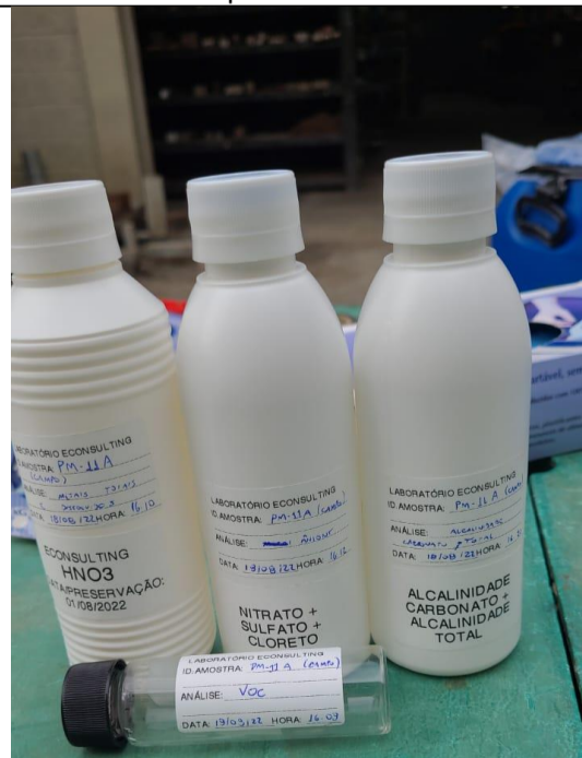
Amostras coletadas em campo envasadas em frascaria específica fornecida pelo laboratório analítico com preservantes
