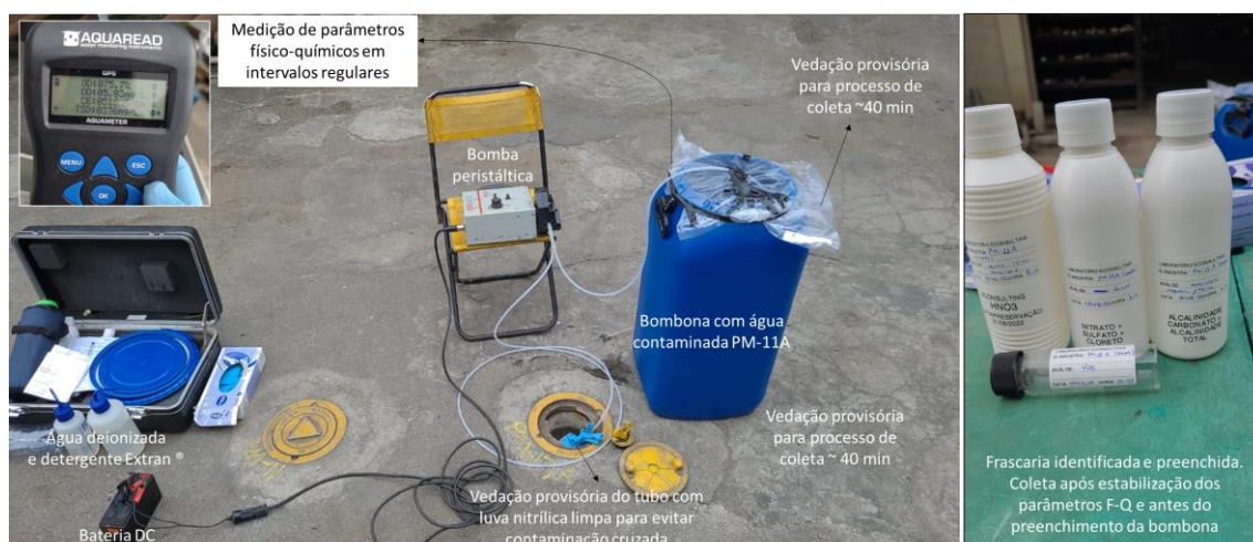
Figura 23 – Procedimento de coleta em campo
