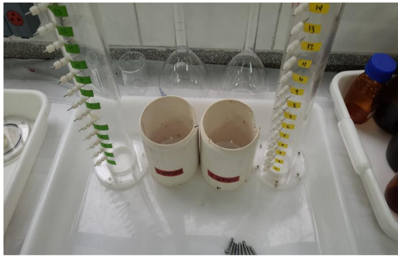
Limpeza sistemática com jatos de água (baixa pressão) para evitar criação de rugosidades internas e ciclos de enxágue com detergente Extran® e água deionizada
