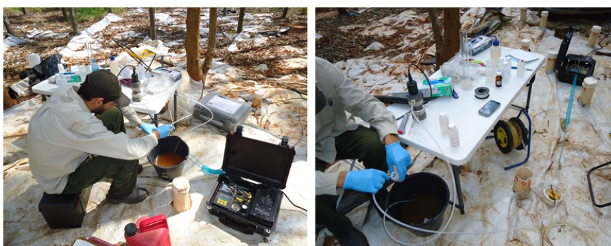
Figura 13 - Amostragem de água pelo método de baixa vazão
