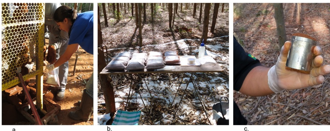
Figura 11 - Amostras de solo coletadas durante a perfuração da sondagem S19, em a coleta direta no trado; em b amostras deformadas, e em c amostra indeformada coletada em cilindro
