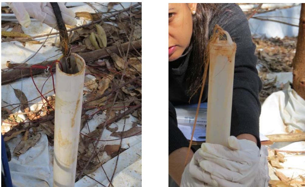
Figura 15 – Raízes de eucaliptos envolvendo o medidor de na em 'a', em 'b' envolvendo o bailer, em abril de 2014
