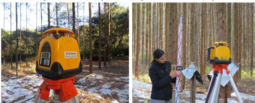
Figura 12 - Verificação da topografia relativa dos poços
