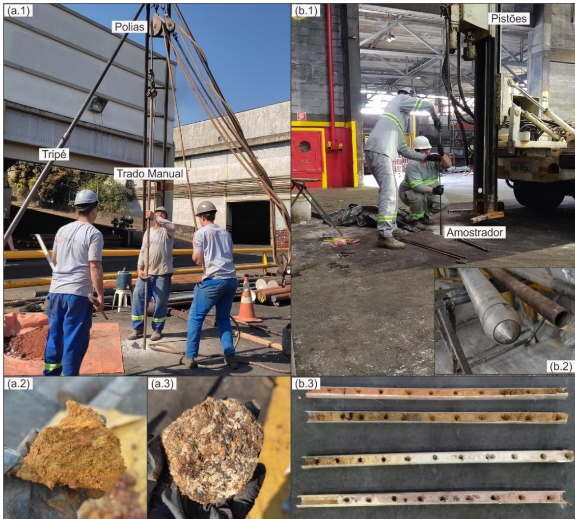
Figura 3.2: Métodos de sondagem empregados na área de estudo. (a) Sondagem por trado manual: (a.1) arranjo do equipamento para sondagem manual; (a.2) amostra deformada do solo de alteração de rocha coletada por trado manual; (a.3) amostra deformada do solo da rocha alterada mole coletada por trado manual. (b) Sondagem mecanizada: (b.1) arranjo do equipamento para sondagem por direct push e momento em que o bico do amostrador é acionado; (b.2) bico do amostrador piston sampler , o qual é acionado em superfície para dar início a coleta; (b.3) amostras indeformadas de um perfil de sondagem coletadas em liner por direct push .
