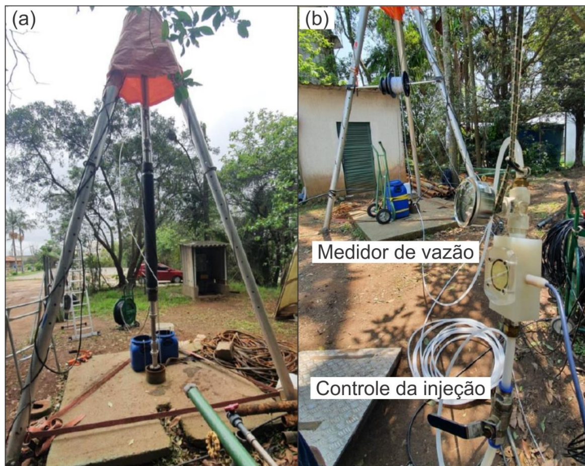
Figura 3.11: Arranjo dos equipamentos utilizados durante o ensaio de perda d'água sob pressão. (a) montagem dos obturadores no poço tubular, com o obturador superior em destaque; (b) arranjo utilizado durante o teste de perda d'água sob pressão, em destaque a válvula para controle da vazão e aumento de acordo com o estágio do teste e medidor da vazão estipulada.
