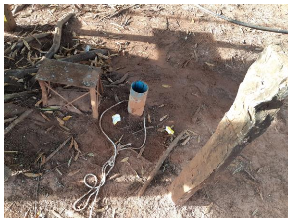
Figura 19: O poço PT-37 foi recuperado e utilizado para instalação de transdutor de pressão.
