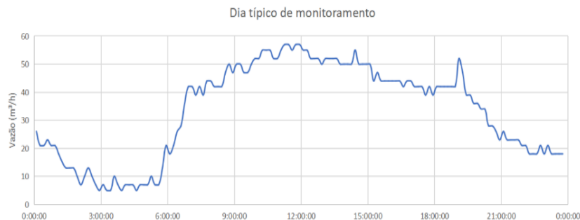
Figura 25: Perfil da vazão de esgoto de um dia típico que passa pela calha Parshall. Vazão mínima de 5m 3 /h que ocorre entre 3:00 e 6:00 horas e vazão máxima que alcança 58m 3 /h aproximadamente às 12:00 horas.
